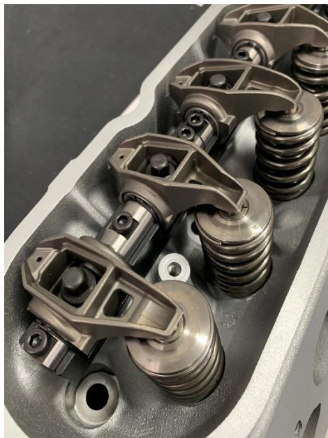
Εικόνα 1-1 Συναρμολόγηση ζυγώθρων
