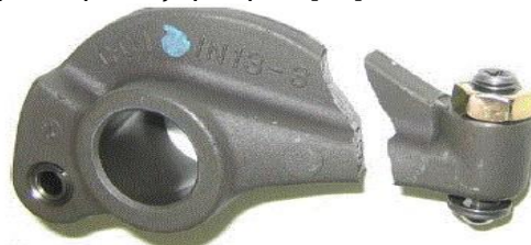
Εικόνα 1-10 Θραύση στο λαιμό του ζύγου
