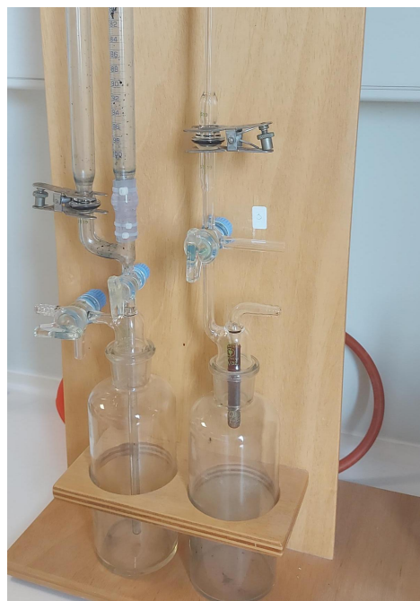
Εικ 32: Φωτογραφίες ασβεστόμετρου Bernard στον εργαστηριακό χώρο
