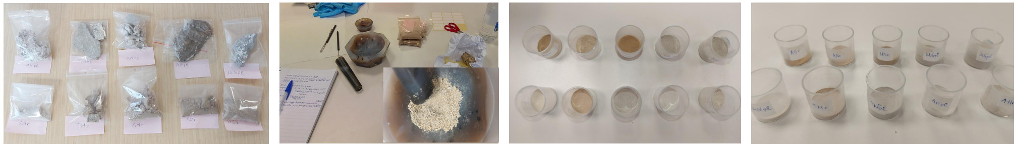
Εικ 29: Προετοιμασία υλικών για FTIR (αρχικά δείγματα, σπάσιμο με γουδί, σκόνες δειγμάτων που χρησιμοποιήθηκαν)
