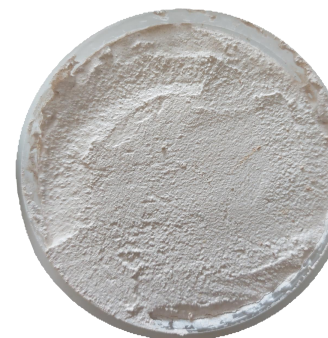
Εικ 74: Ασβεστοχρωμάτων μέσα σε υπόστρωμα σοβά μετά από 1 μήνα
