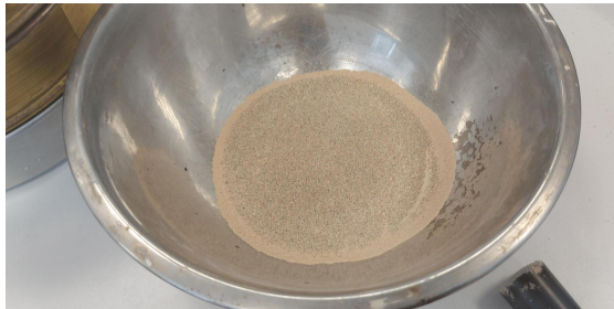
Εικ 23: Διαδικασία κοκκομετρίας (κοσκίνισμα δείγματος και ζύγισμα συγκρατούμενης ποσότητας)
