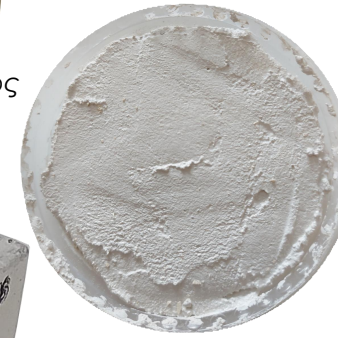
Εικ 74: Ασβεστοχρωμάτων μέσα σε υπόστρωμα σοβά μετά από 1 μήνα
