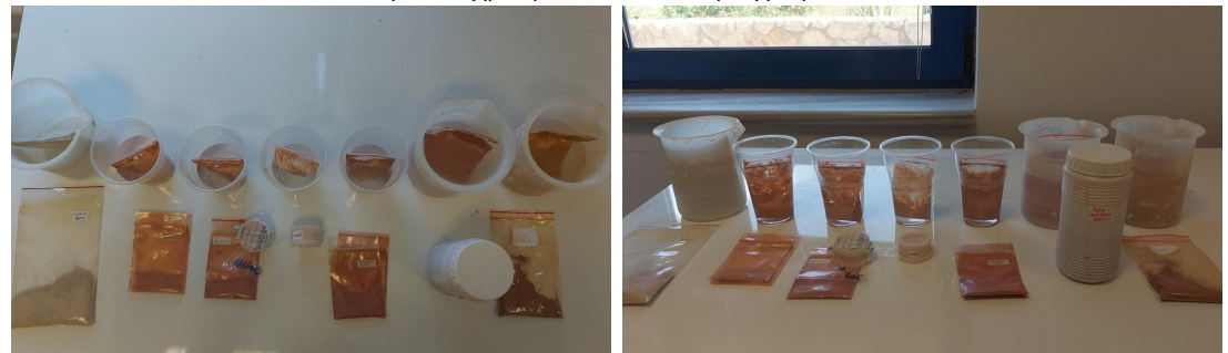
Εικ 38: Πηλοί με ασβέστη εμβαπτισμένοι στο νερό
