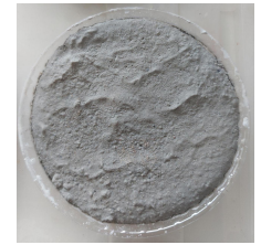
Στέγνωμα ασβεστοχρώματος
