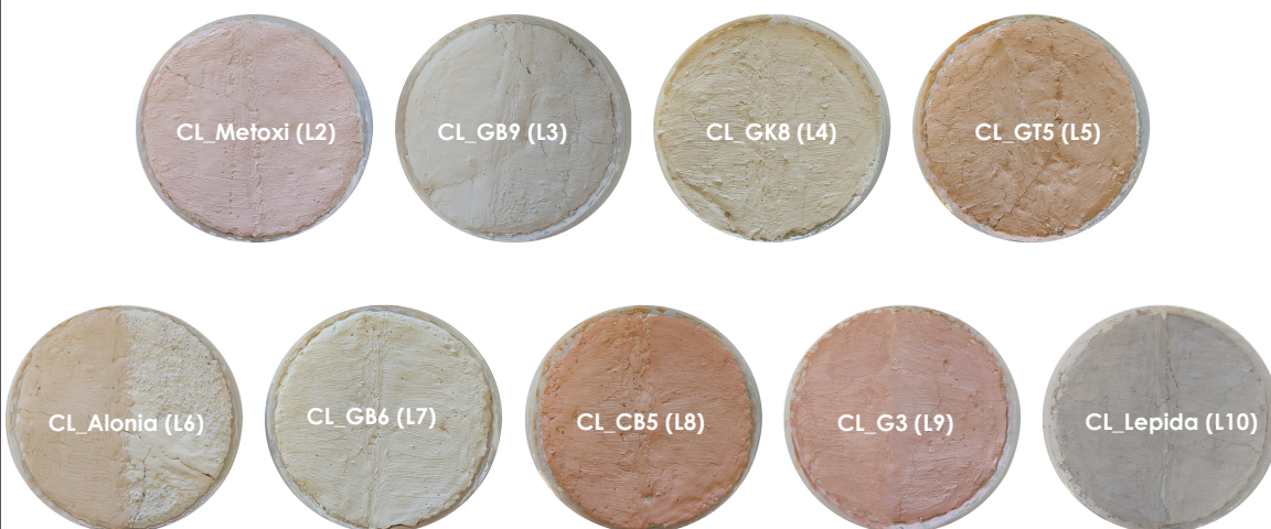
Εικ 46: Ασβεστοχρώματα ως τελικό στρώμα επάλειψης
