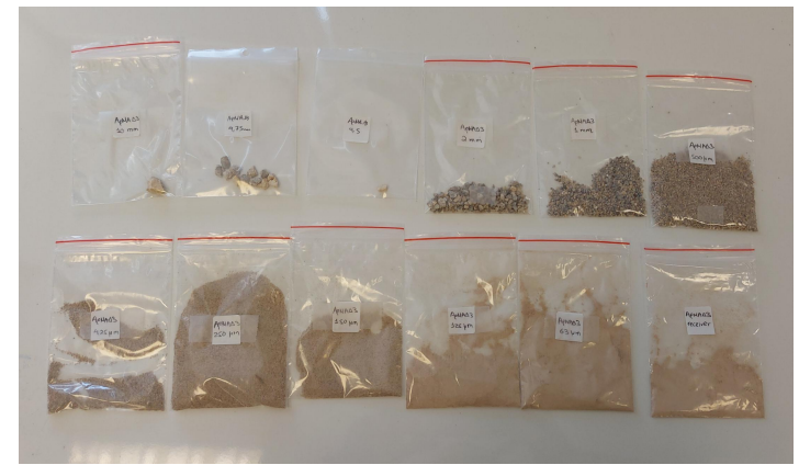
Εικ 22: Κλάσματα κοκκομετρικής ανάλυσης δείγματος ΑρΜΑ Δ3
