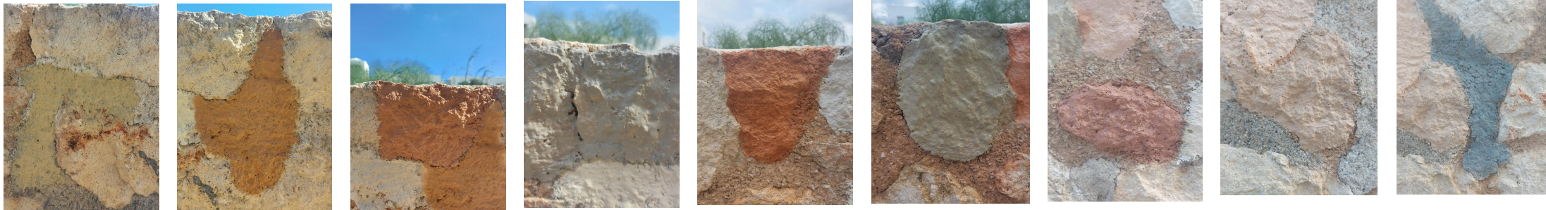
Εικ 66: Αβεστοχρώματα μόλις επαλείφθηκαν σε πέτρινο τοίχο
