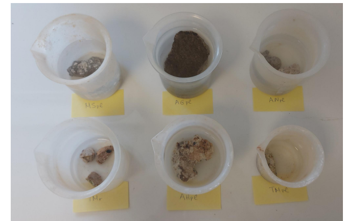
Εικ 28: Εμβάπτισμα δειγμάτων στο νερό
