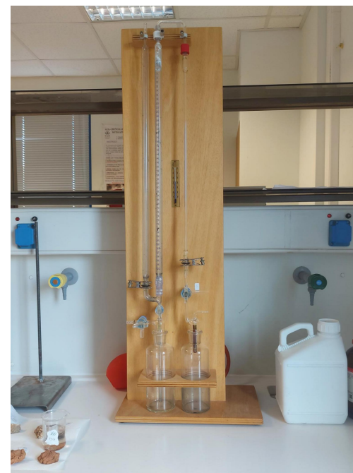
Εικ 32: Φωτογραφίες ασβεστόμετρου Bernard στον εργαστηριακό χώρο
