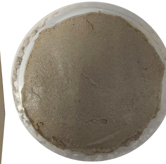
Εικ 73: Εφαρμογή ασβεστοχρωμάτων μέσα σε υπόστρωμα σοβά
