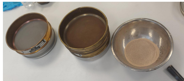
Εικ 23: Διαδικασία κοκκομετρίας (κοσκίνισμα δείγματος και ζύγισμα συγκρατούμενης ποσότητας)
