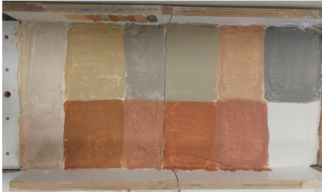
Εικ 62: Σοβάς μετά την εφαρμογή των ασβεστοχρωμάτων πριν & αφού στεγνώσουν (μετά από 1 μήνα)
