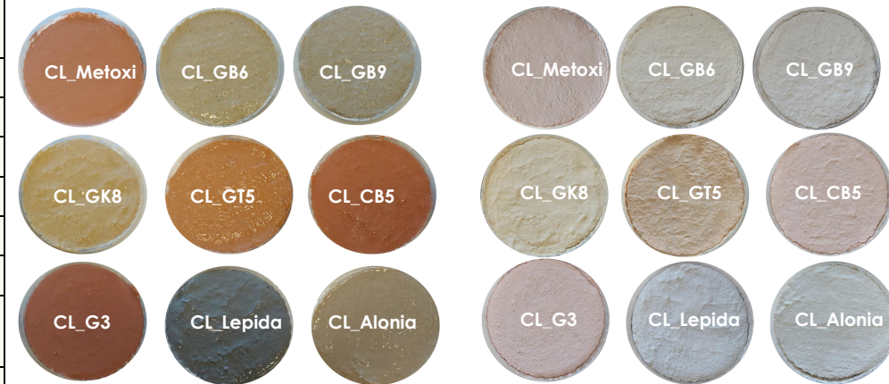
Εικ 42: Προσμίξεις ασβεστοχρωμάτων πριν & αφού στεγνώσουν
