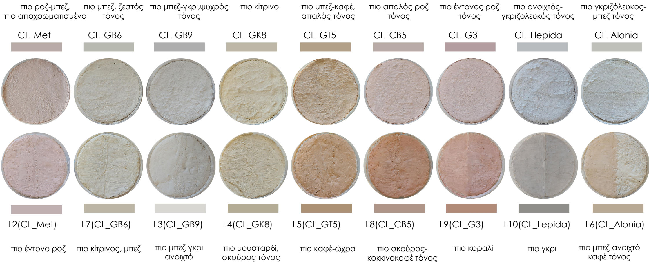
Εικ 58: Σύγκριση ασβεστοχρωμάτων από τον ίδιο πηλό
