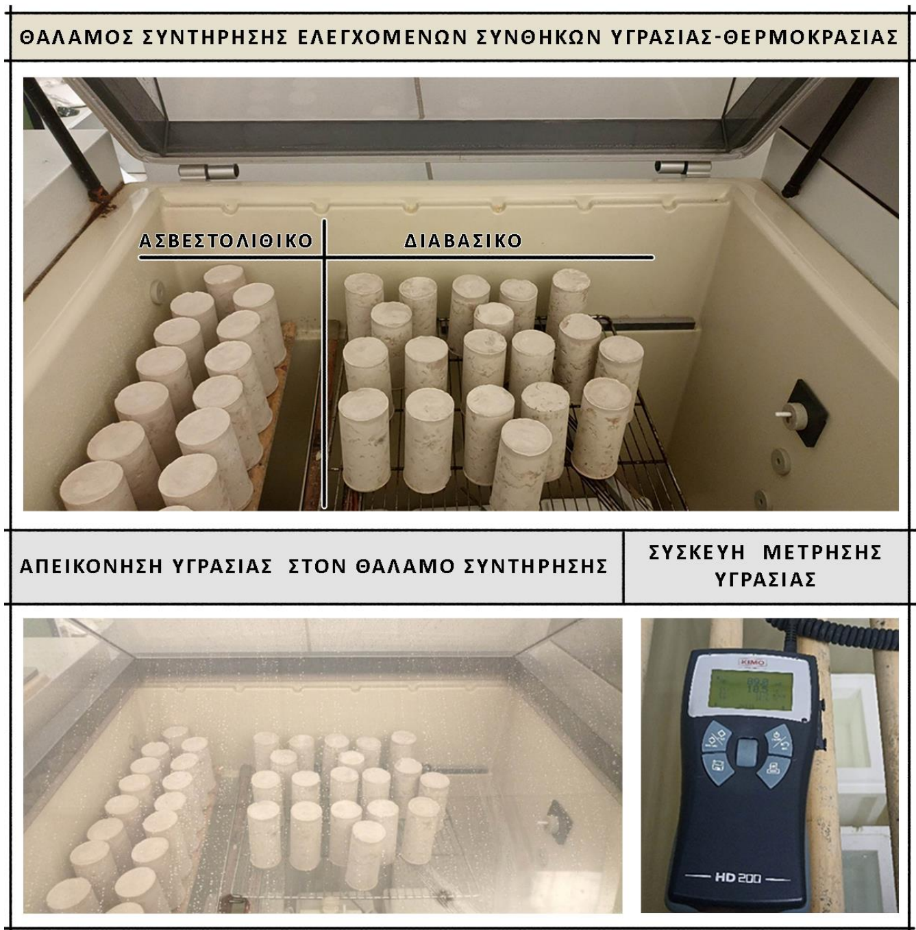
Εικόνα 35: Θάλαμος συντήρησης ελεγχόμενων συνθηκών υγρασίας-θερμοκρασίας ασβεστολιθικών και διαβασικών δοκιμίων.
