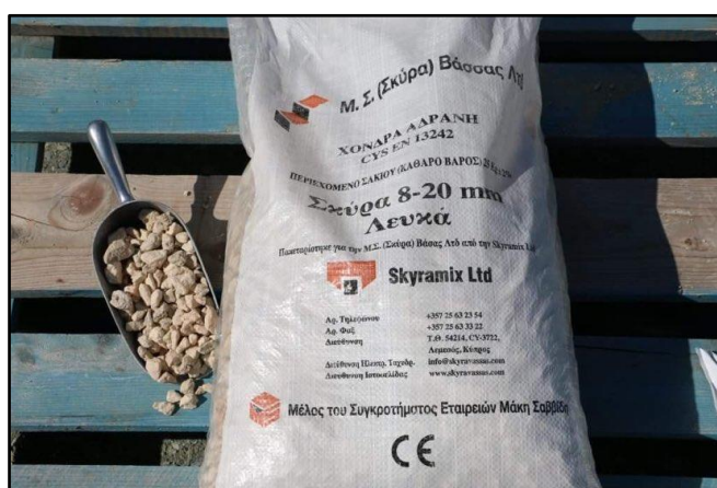
Εικόνα 9: Ασβεστολιθικό πέτρωμα 5 κιλών και κοκκομετρίας 8-20mm από το οποίο εξορύσσετε από το λατομείο Chapo Mitsero και προμηθεύεται από το λατομείο Skyra Vassas Ltd.
