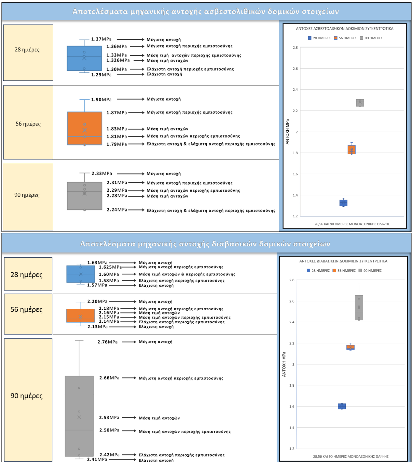
Εικόνα 38 : Αναφορά και επεξήγηση των τιμών αντοχών του πίνακα 24 για τα ασβεστολιθικά & διαβασικά δοκίμια.
