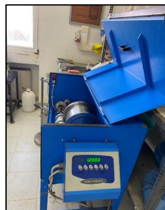
Εικόνα 21: Συσκευή micro-Deval όπου απεικονίζεται η ρύθμιση των στροφών.
