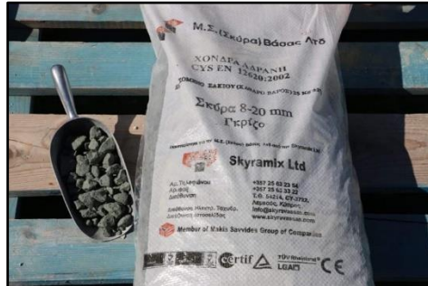
Εικόνα 7: Διαβασικό πέτρωμα 5 κιλών και κοκκομετρίας 8-20mm από το λατομείο Skyra Vassas Ltd.
