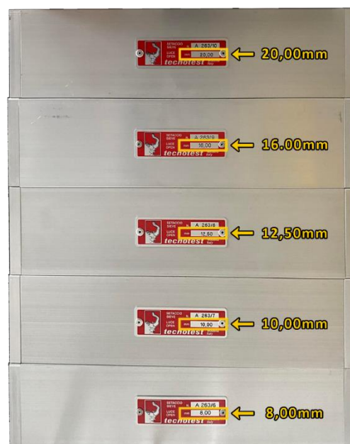
Εικόνα 17: Στήλη κόσκινων με μπάρες.
