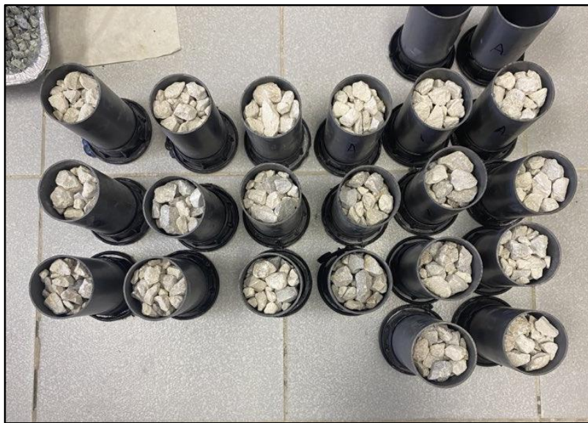
Εικόνα 28: Κάτοψη τοποθέτησης ασβεστολιθικού πετρώματος στα καλούπια.
