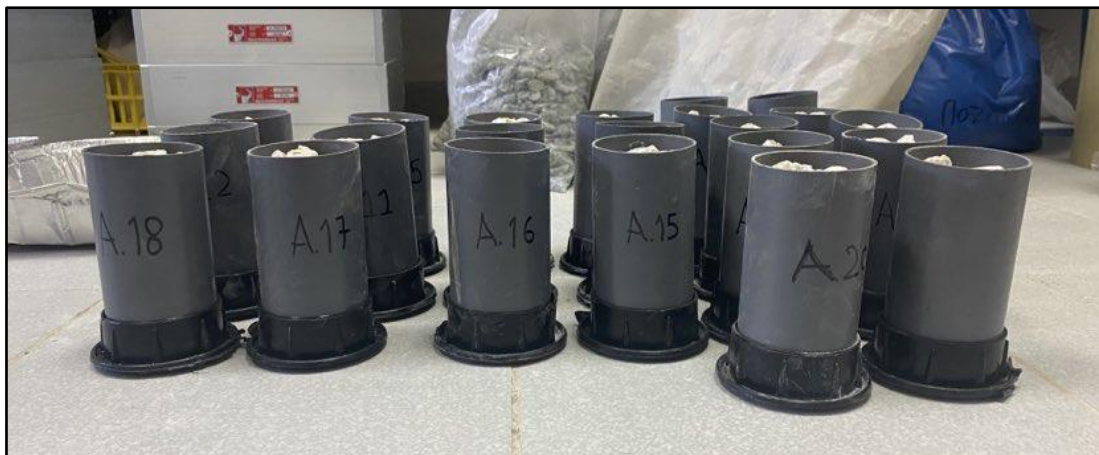
Εικόνα 29: Όψη τοποθέτησης ασβεστολιθικού πετρώματος στα καλούπια.
