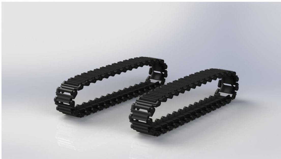
Εικόνα 4.3 Σετ ερπύστριας εκσκαφέα, όπως σχεδιάστηκε στο SOLIDWORKS
