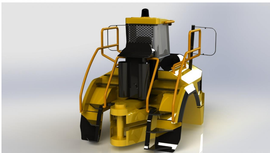
Εικόνα 5.4 Καμπίνα αρθρωτού ανατρεπόμενου φορτηγού Volvo A60H σε οπίσθια πλάγια όψη, όπως σχεδιάστηκε στο SOLIDWORKS.
