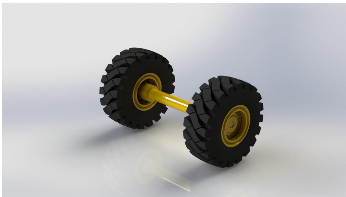
Εικόνα 5.8 Άξονας κίνησης και τροχοί αρθρωτού ανατρεπόμενου φορτηγού, όπως σχεδιάστηκε στο SOLIDWORKS.
