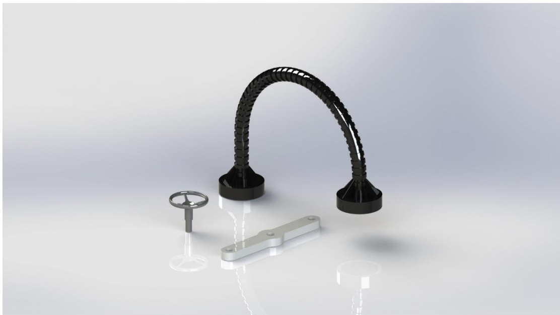
Εικόνα 5.10 Άξονες στροφής σωλήνας σύνδεσης καλωδίων και τιμόνι φορτηγού, όπως σχεδιάστηκε στο SOLIDWORKS.
