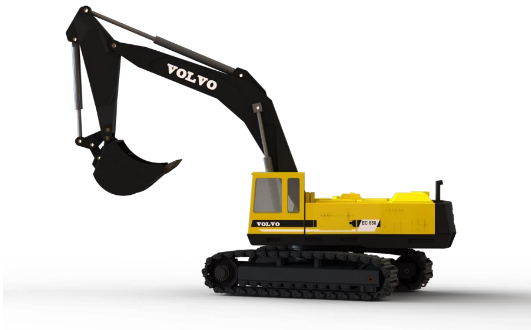
Εικόνα 3.1 Τρισδιάστατη προοπτική του εκσκαφέα Volvo EC650, όπως σχεδιάστηκε στο SOLIDWORKS.
