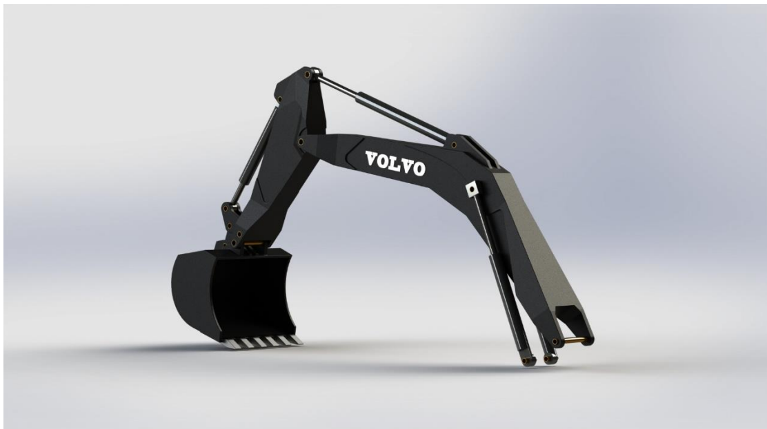
Εικόνα 4.8 Υδραυλικό σύστημα μπούμας - κάδου εκσκαφέα εξωτερική όψη, όπως σχεδιάστηκε στο SOLIDWORKS
