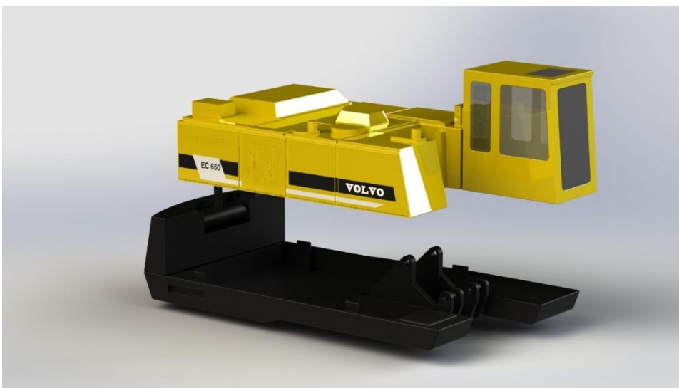
Εικόνα 4.6 Περιστρεφόμενη βάση και περίβλημα καμπίνας πλάγια δεξιά όψη, όπως σχεδιάστηκε στο SOLIDWORKS
