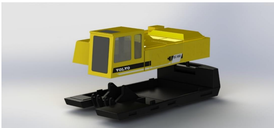
Εικόνα 4.5 Περιστρεφόμενη βάση και περίβλημα καμπίνας πλάγια δεξιά όψη, όπως σχεδιάστηκε στο SOLIDWORKS
