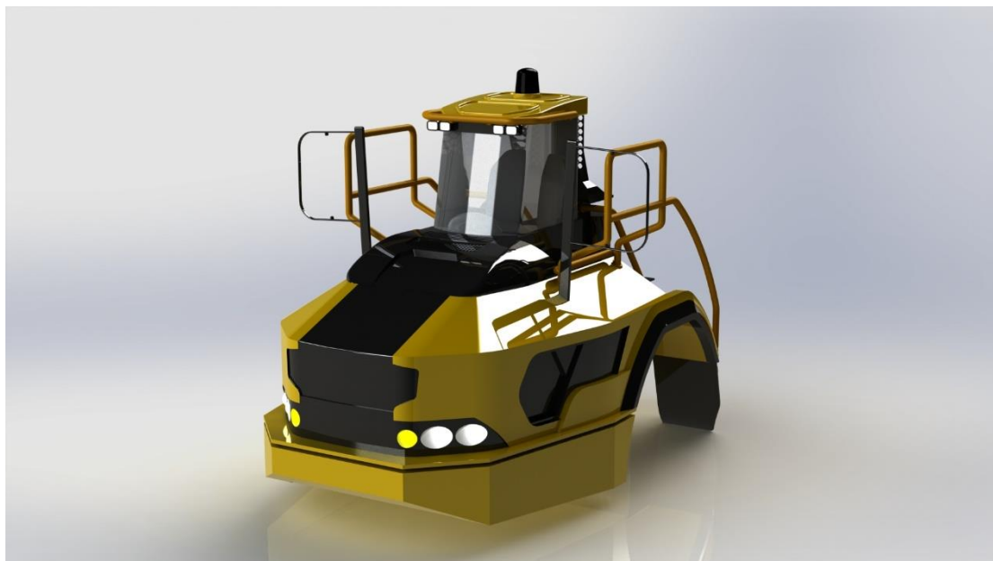
Εικόνα 5.3 Καμπίνα αρθρωτού ανατρεπόμενου φορτηγού Volvo A60H σε εμπρόσθια πλάγια όψη, όπως σχεδιάστηκε στο SOLIDWORKS.
