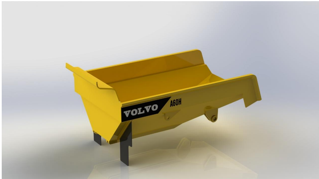
Εικόνα 5.5 Σκάφη ανατροπής εμπρόσθια πλάγια όψη, όπως σχεδιάστηκε στο SOLIDWORKS.
