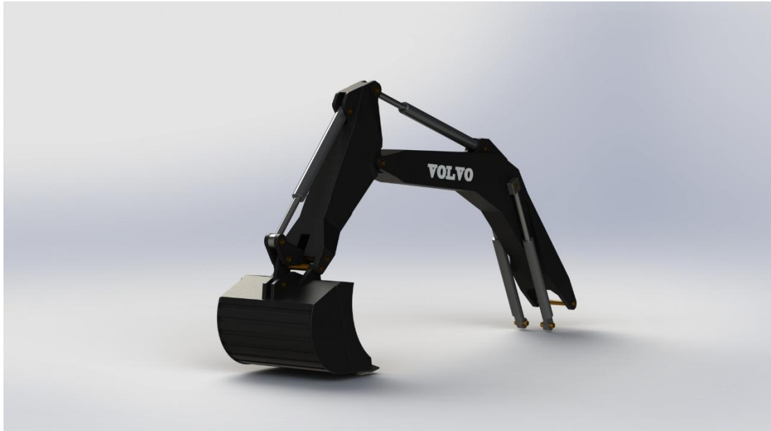
Εικόνα 4.7 Υδραυλικό σύστημα μπούμας - κάδου εκσκαφέα εξωτερική όψη, όπως σχεδιάστηκε στο SOLIDWORKS
