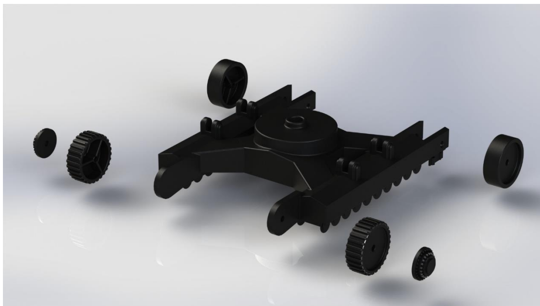
Εικόνα 4.4 Συναρμολόγηση ερπυστριοφόρου βάσεως εκσκαφέα, όπως σχεδιάστηκε στο SOLIDWORKS.
