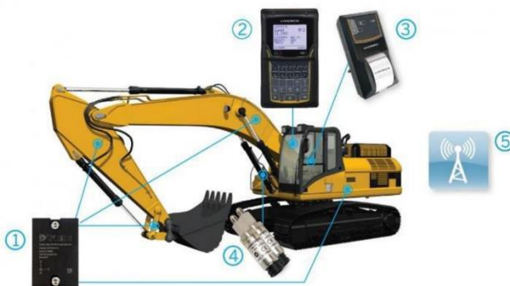
Εικόνα 2.4 Σύστημα ωφέλιμου φορτίου, 1 - Αισθητήρας γωνίας, 2 - Δείκτης, 3 - Εκτυπωτής, 4 - Μορφοτροπέας πίεσης, 5 - Δεδομένα επικοινωνίας
