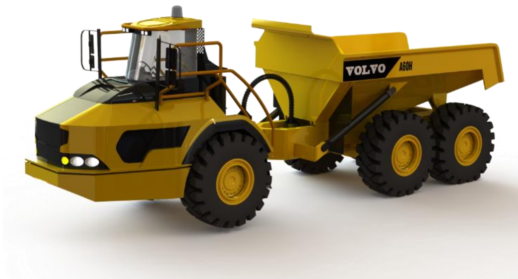
Εικόνα 3.2 Τρισδιάστατη προοπτική του αρθρωτού ανατρεπόμενου φορτηγού Volvo A60H, όπως σχεδιάστηκε στο SOLIDWORKS.
