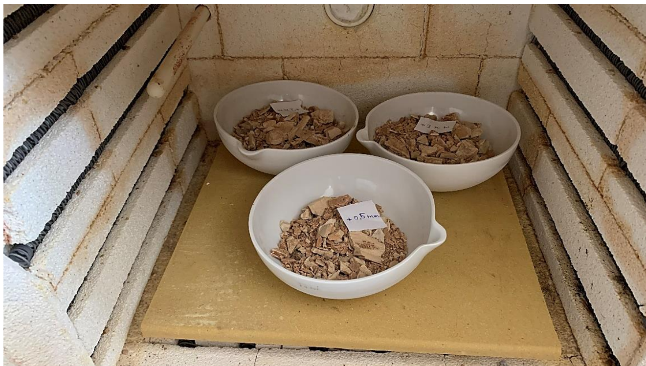
Εικόνα 7: Δείγματα στο κλίβανο πριν τη πύρωση
