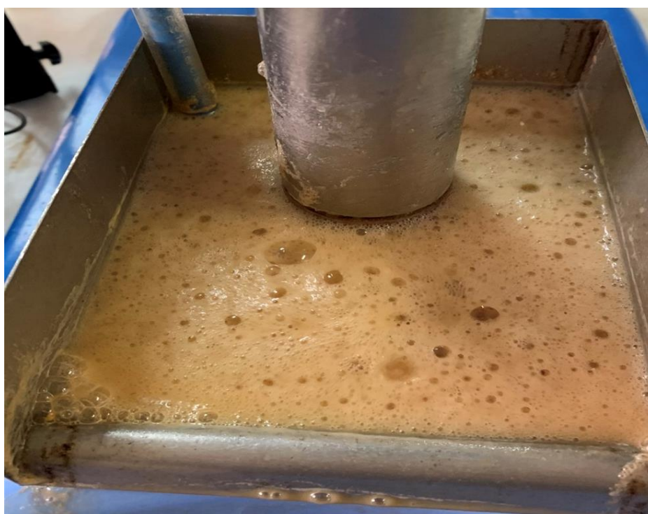
Εικόνα 8: Δοκιμή επίπλευσης δείγματος φωσφορίτη
