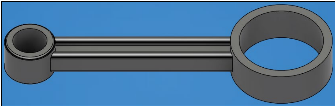
Εικόνα 6.1.30 Μορφοποίηση της μπιέλας με την εντολή Fillet .
