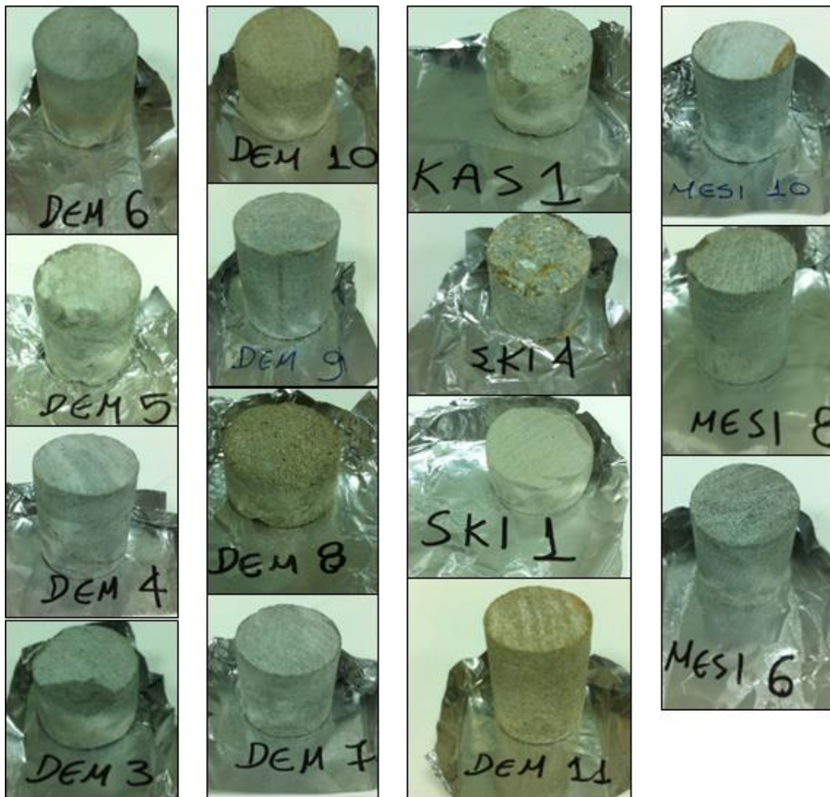
Εικόνα 4-35: Παράδειγμα δοκιμίων διαμέτρου 1 ίντσας που χρησιμοποιήθηκαν για τις εργαστηριακές μετρήσεις πορώδους και διαπερατότητας.
