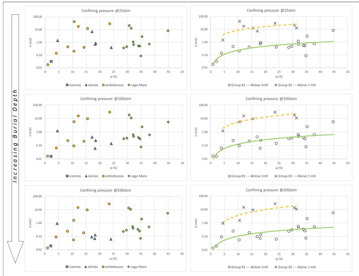
Διάγραμμα 4-10: Επιμέρους διαγράμματα πορώδους/διαπερατότητας για διαφορετικές τιμές ακτινωτής πίεσης που αντιπροσωπεύει τις αντίστοιχες πιέσεις υπερκειμένων (overburden pressure). Κάθε πίεση υπερκειμένων αντιστοιχεί σε 200m, 400m και 800m αντίστοιχα. Στην πρώτη στήλη παρουσιάζονται τα σημεία ανά στρωματογραφική ενότητα που ανήκουν. Στη δεύτερη στήλη παρουσιάζονται τα ίδια σημεία ομαδοποιημένα σε «άνω του 1mD» και «κάτω του 1mD». Σημειώνεται ότι κάθε ομάδα δε ξεπερνά τις 2 τάξεις μεγέθους σε διαπερατότητα.
