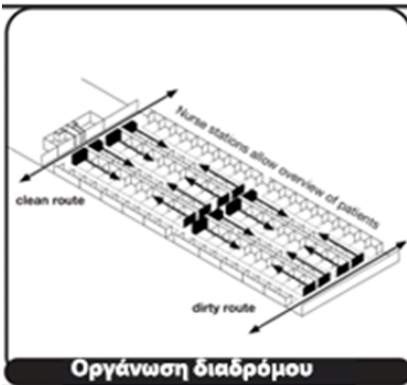
Κάτοψη πτέρυγας του Νοσοκομείου του Λονδίνου στα τέλη του 19ου αιώνα με την αμφίπλευρη διάταξη κλινών εκατέρωθεν αξονικού τοιχώματος (back-to-back plan). (Πηγή: Ξανθόπουλος, 2016)
