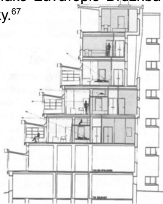
Εικόνα 2.1.39: Βαθμιδωτή τομή και ελεγχόμενος ηλιασμός στο Σανατόριο Guebriant
