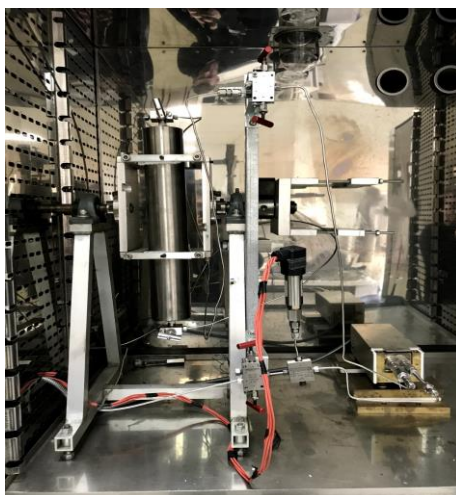
Σχήμα 5.6: Το αυτόκλειστο κελί εντός του θερμοθαλάμου
