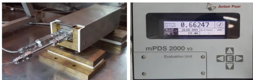
Σχήμα 5.8: Εσωτερική μονάδα πυκνόμετρου τοποθετημένη μέσα στο θερμοθάλαμο (αριστερά) και Εξωτερική μονάδα συλλογής μετρήσεων (δεξιά)
