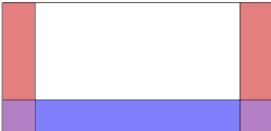
Εικόνα 2.13: Σχηματική αναπαράσταση απορροφητικών ορίων (γραμμοσκιασμένες περιοχές) μοντέλου 2 διαστάσεων (2D). Το ανώτερο μέρος του μοντέλου αντιστοιχεί σε ελεύθερη επιφάνεια (Πηγή: Petersson & Sjogreen, 2016).
