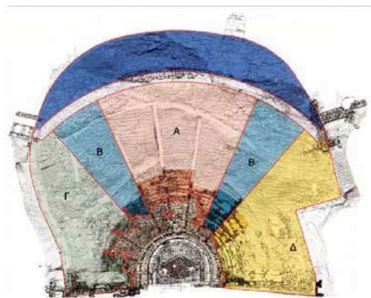
Εικ. 90: Σταδιακή αποκατάσταση του κοίλου. Η κατώτερη περιοχή θα παραμείνει ως έχει, ενώ οι υπόλοιπες θα αποκατασταθούν σε διαδοχικά στάδια (Α, Β, Γ, Δ) (Επιστημονική Επιτροπή Θεάτρου και Ιερού του Διονύσου-Ασκληπιείου Νοτίου Κλιτύος Ακροπόλεως 2009, 20)
