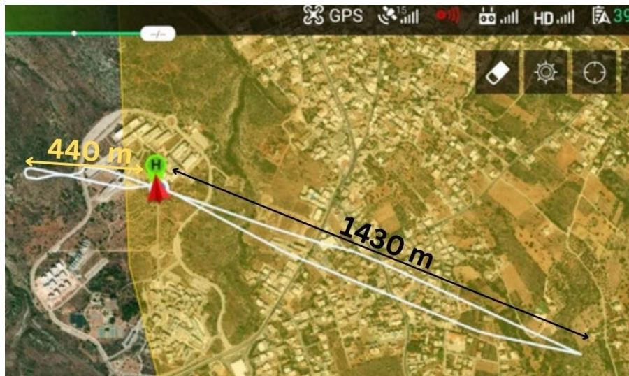
Σχήμα 4-16: Μετάδοση με οπτική επαφή (μαύρο), μετάδοση με παρεμβολή εμποδίου (κίτρινο).
