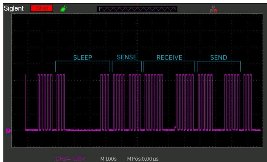
Σχήμα 4-10: Απεικόνιση εξόδου LED για την αναγνώριση των καταστάσεων λειτουργίας.
