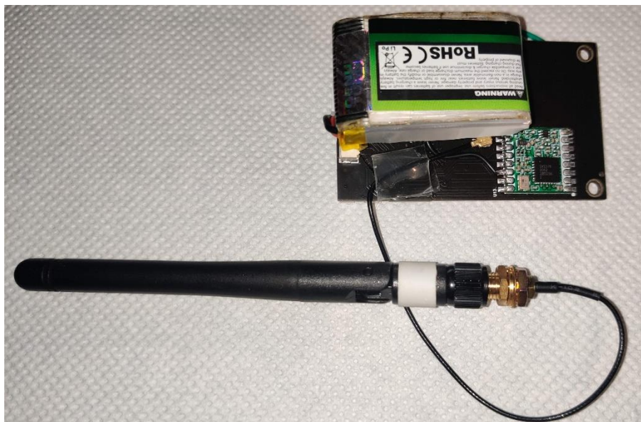
Σχήμα 3-11: RFM95 τοποθετημένο στην πλακέτα.
