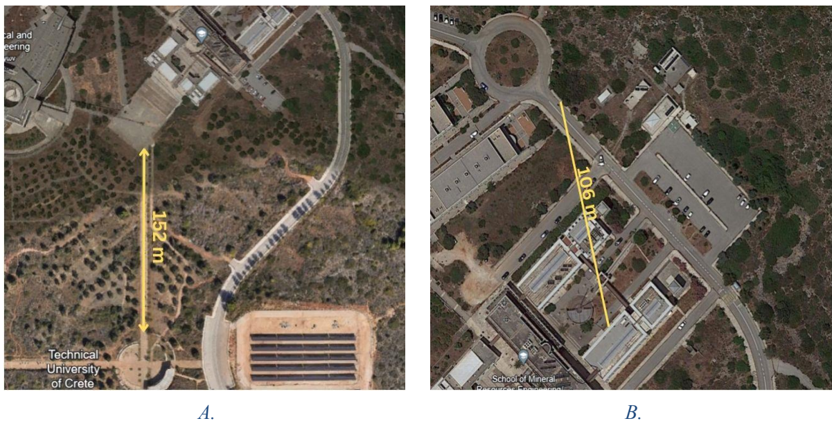
Σχήμα 4-18: Μετάδοση με οπτική επαφή (A), μετάδοση με παρεμβολή εμποδίου (B).
