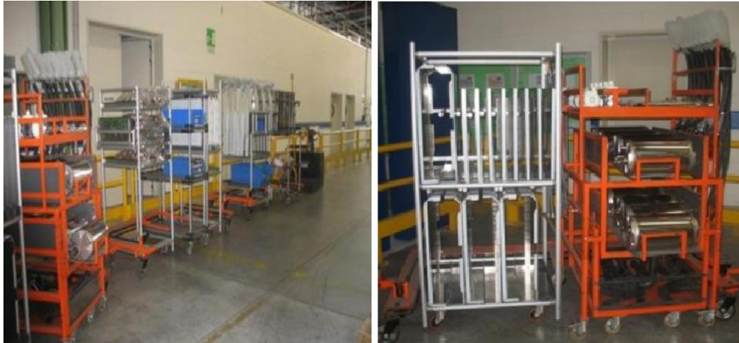
Εικόνα 4.3: Συρμοί καροτσιών για την ανακατασκευή των εξαρτημάτων κατά μήκος των γραμμών συναρμολόγησης (Πηγή: Del Fabbro & Santarossa, 2016)
