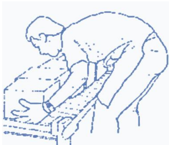
Εικόνα 1.5: Σκύψιμο του εργαζομένου λόγω του χαμηλού ύψους του ταινιόδρομου (Πηγή: Simoneau et al., 1996)
