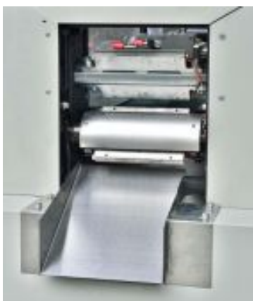
Σχήμα 3.7 Μηχάνημα συσκευασίας- τέλος σφράγισης
