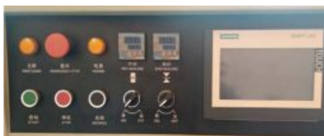
Σχήμα 3.6 Πίνακας βασικών ρυθμίσεων (βάρους, θερμοκρασίας, ταχύτητας κοπής κ.ά.)
