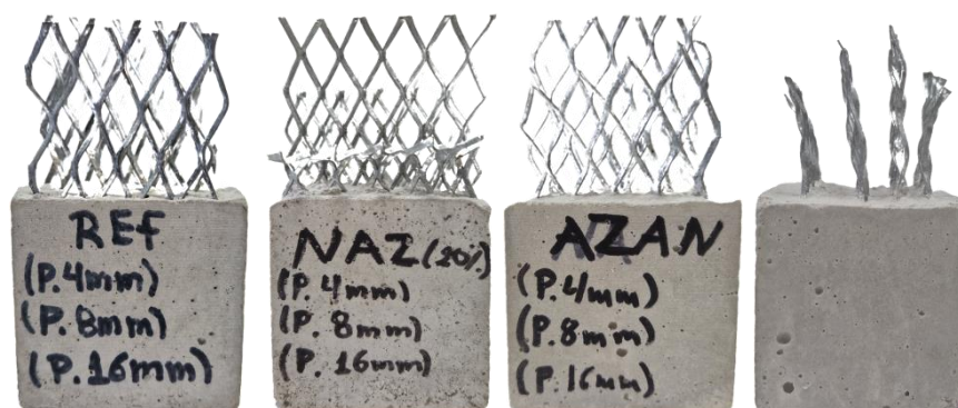
Σχήμα 5.10. Σειρά παρασκευασθέντων δοκιμίων και πλάγια όψη ενός εξ αυτών όπου φαίνονται τα 3 ζεύγη των ηλεκτροδίων (πλέγμα) σε αποστάσεις 4, 8 και 16 mm.
