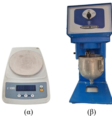
Σχήμα 5.5. Εξοπλισμός παρασκευής μιγμάτων: (α) Ζυγός ακριβείας (β) Αναμίκτης τσιμεντοκονιαμάτων.
