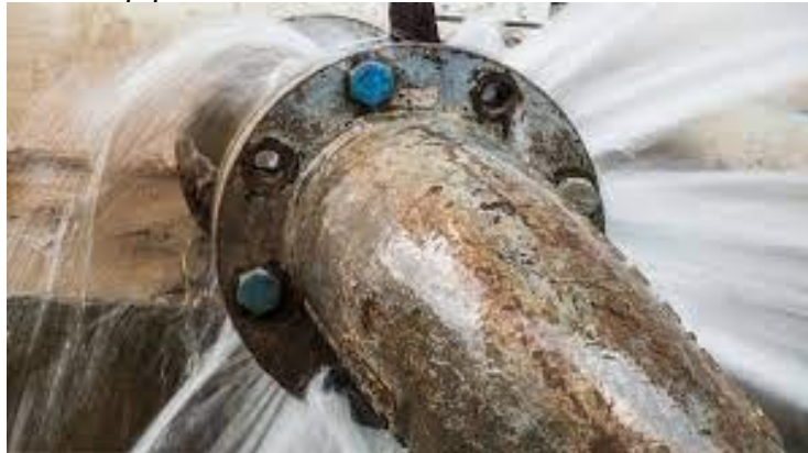
Εικόνα 18. Παράδειγμα διάβρωσης σωλήνα και συνεπώς αστοχία σημείου
