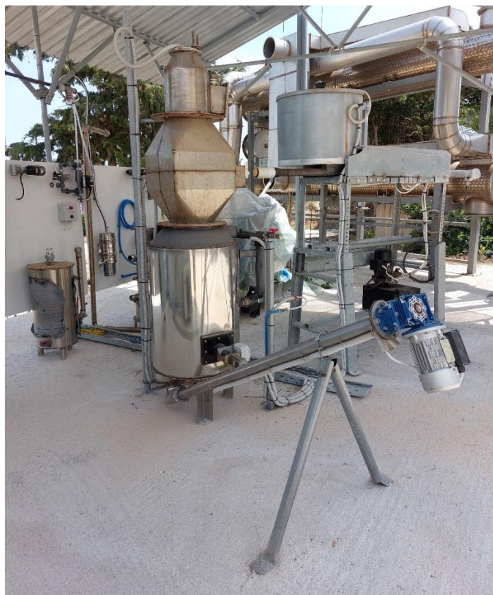
Εικόνα 5.3 Το σύστημα αεριοποίησης του προγράμματος LIFE B2E4sustainable-WWTP.
