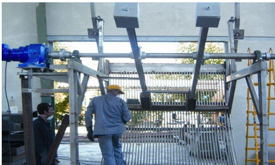
Εικόνα 1.3 Μηχανικά καθαριζόμενη σχάρα (Thajudeen, 2017).
