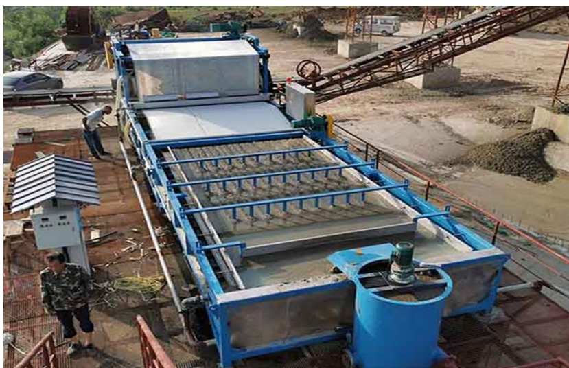
Εικόνα 1.13 Ταινιοφιλτρόπρεσα (Longzhong Machinery, 2015).
