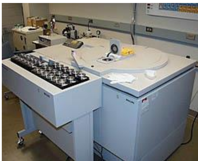
Εικόνα 1: Φασματόμετρο XRF, με τη θύρα δείγματος στην κορυφή, και ένα σύνολο δειγμάτων σε ασημένιες μεταλλικές υποδοχές στον εναλλάκτη δείγματος μπροστά.
