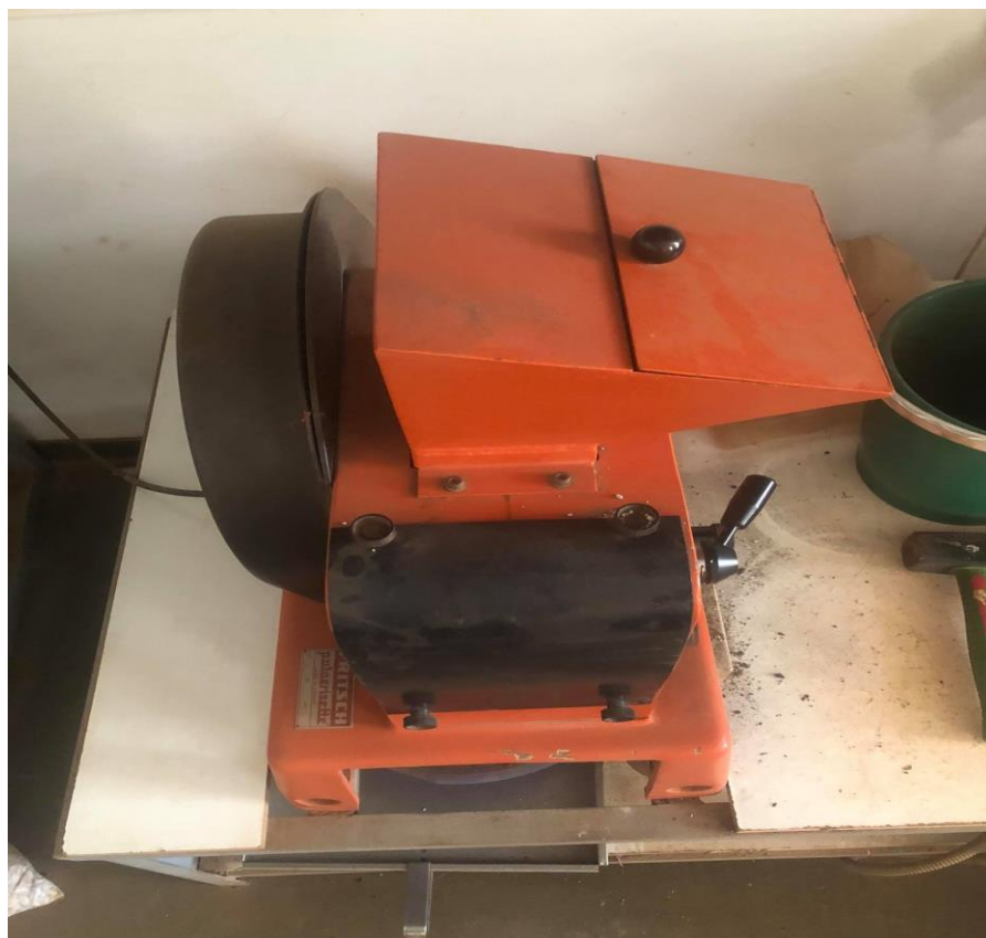
Σχήμα 9: Σιαγονωτός Σπαστήρας
