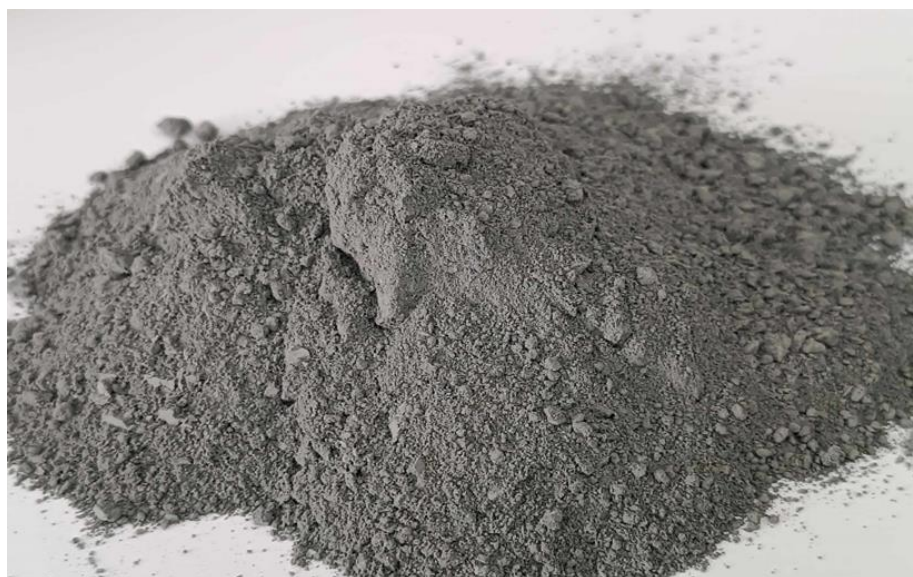
Εικόνα 3.1. Πυριτικά τέλματα επίπλευσης μετά την λειοτρίβηση ( d_{90} < 50 \mu\text{m} ).
