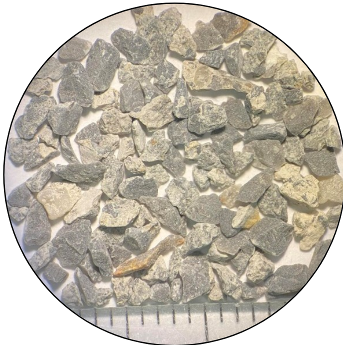
Εικόνα 3.25: Μικροφωτογραφία κόκκων από το κοκκομετρικό κλάσμα +1.00\text{mm} του δείγματος AN10.
