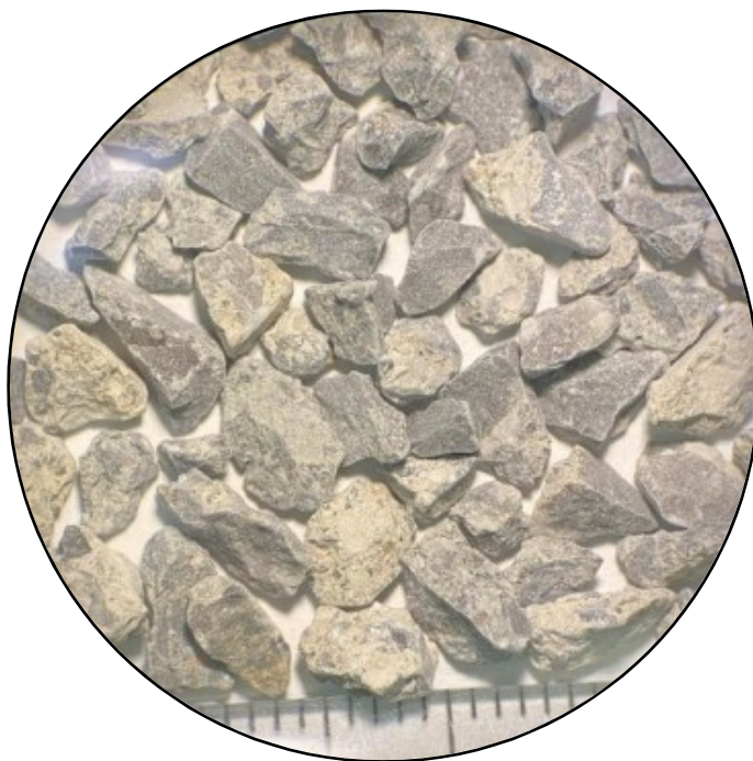
Εικόνα 3.18:Μικροφωτογραφία κόκκων από το κοκκομετρικό κλάσμα +2.00mm του δείγματος AN0.
