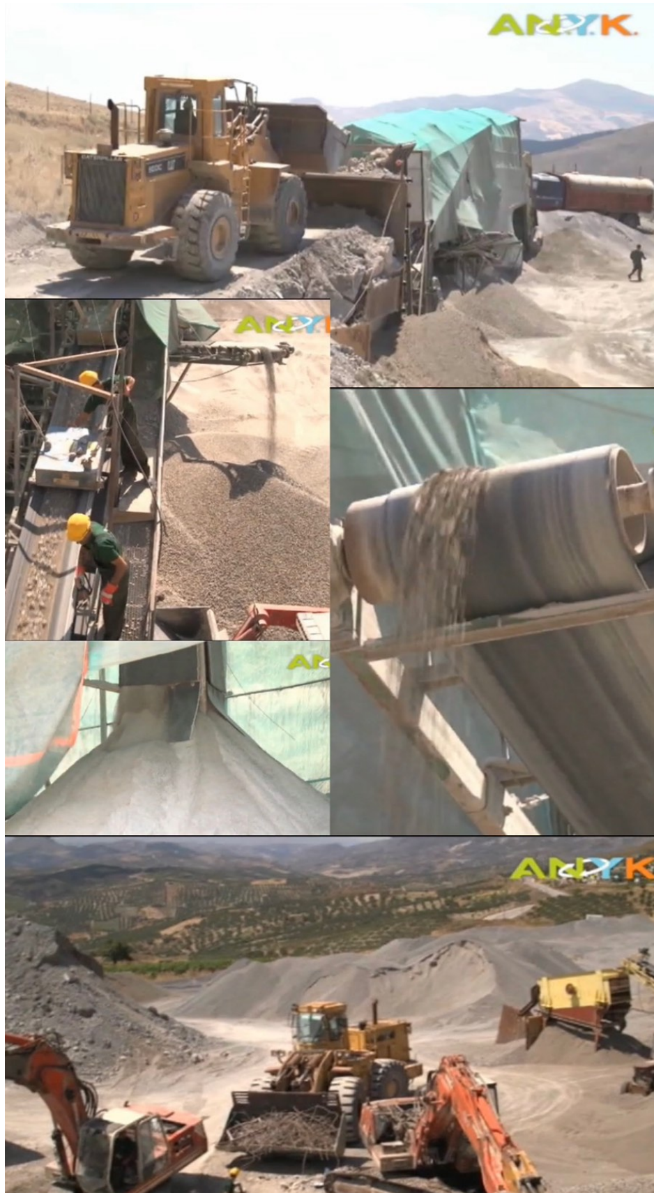
Εικόνα 3.2: Διαχωρισμός και επεξεργασία ΑΕΕΚ για παραγωγή ανακυκλωμένων αδρανών
