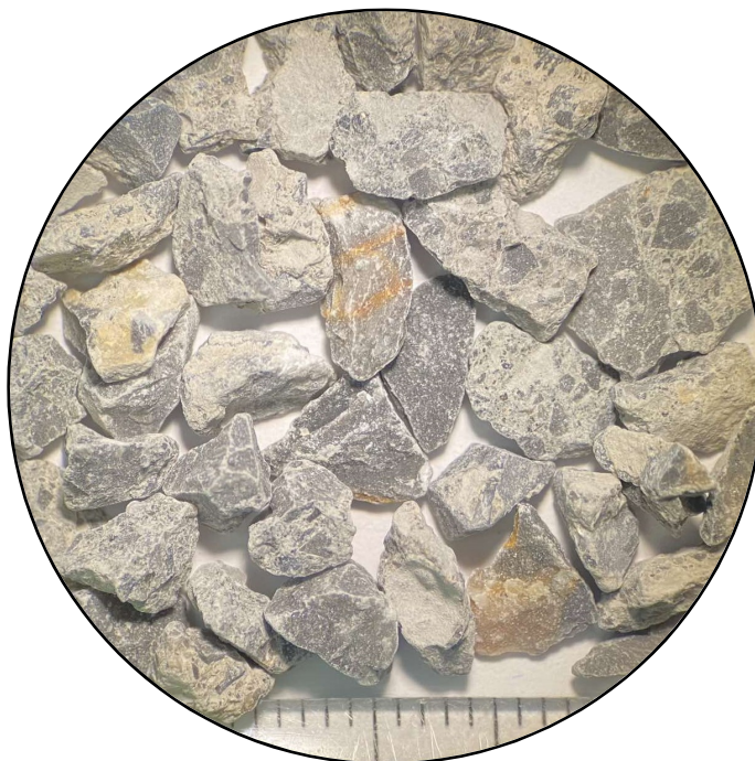
Εικόνα 3.26: Μικροφωτογραφία κόκκων από το κοκκομετρικό κλάσμα +4.00mm του δείγματος AN20.
