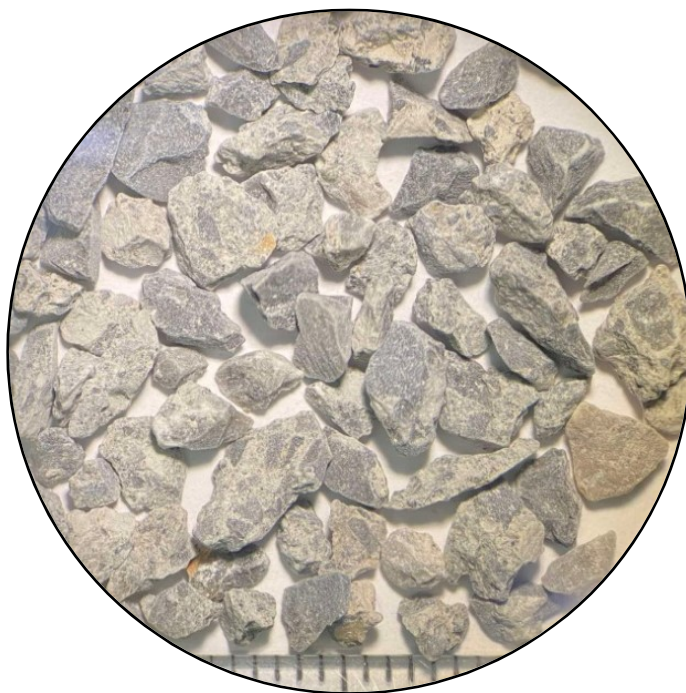
Εικόνα 3.24: Μικροφωτογραφία κόκκων από το κοκκομετρικό κλάσμα +2.00\text{mm} του δείγματος AN10.
