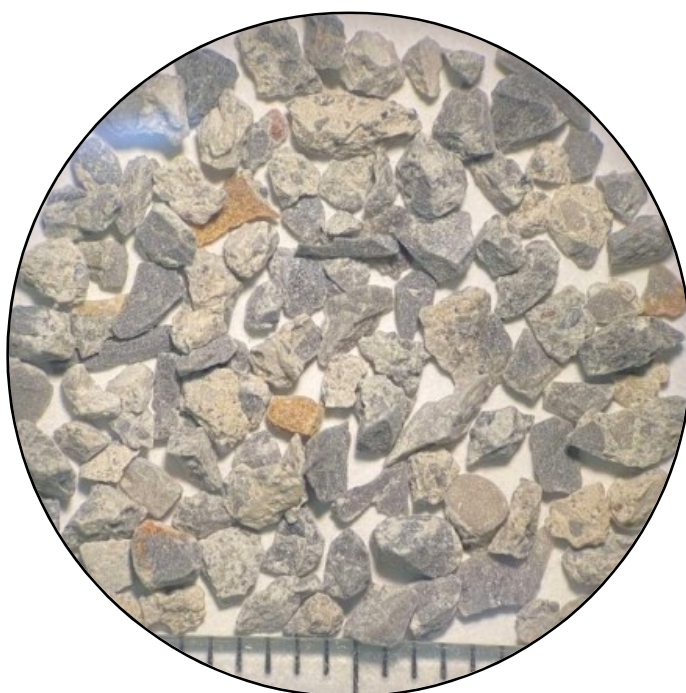
Εικόνα 3.22: Μικροφωτογραφία κόκκων από το κοκκομετρικό κλάσμα +1.00mm του δείγματος AN5.
