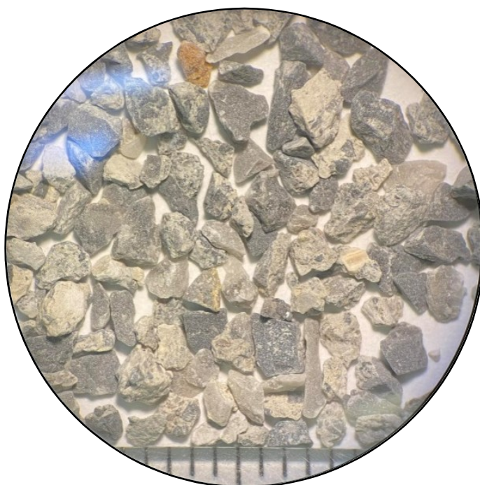
Εικόνα 3.31: Μικροφωτογραφία κόκκων από το κοκκομετρικό κλάσμα +1.00\text{mm} του δείγματος AN40.
