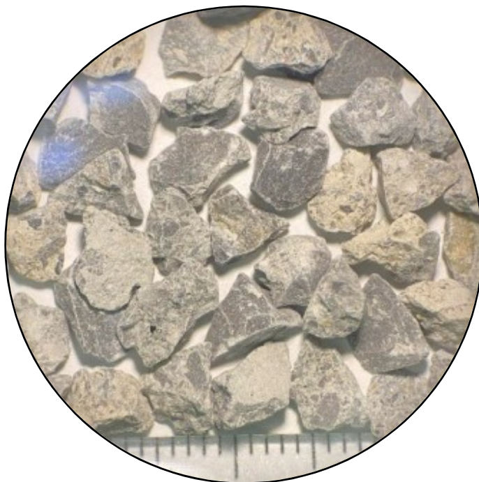
Εικόνα 3.17: Μικροφωτογραφία κόκκων από το κοκκομετρικό κλάσμα +4.00mm του δείγματος AN0.
