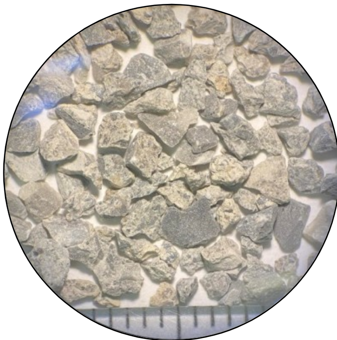
Εικόνα 3.19: Μικροφωτογραφία κόκκων από το κοκκομετρικό κλάσμα +1.00mm του δείγματος AN0.
