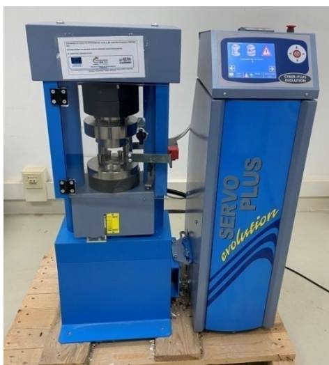
Εικόνα 4.7: Σύστημα Ελέγχου Αντοχής σε κάμψη/θλίψη δοκιμών τσιμεντοκονιαμάτων κατά EN 196-1. (Matest E161-03N)
