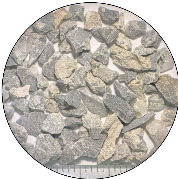
Εικόνα 3.27: Μικροφωτογραφία κόκκων από το κοκκομετρικό κλάσμα +2.00\text{mm} του δείγματος AN20.
