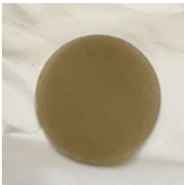
3.13: Μορφοποιημένος δίσκος (pellet) για ανάλυση με FTIR
