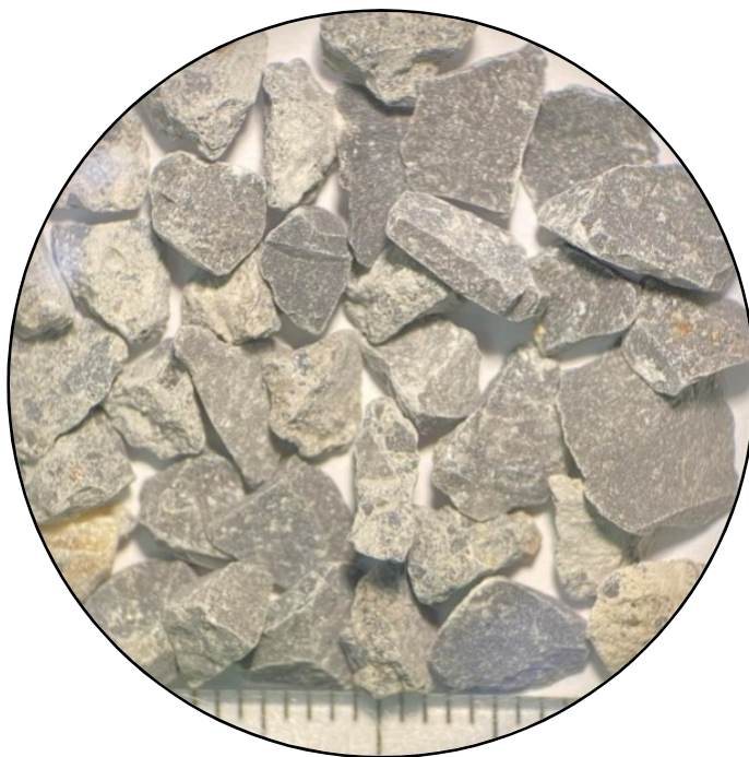
Εικόνα 3.23: Μικροφωτογραφία κόκκων από το κοκκομετρικό κλάσμα +4.00mm του δείγματος AN10.
