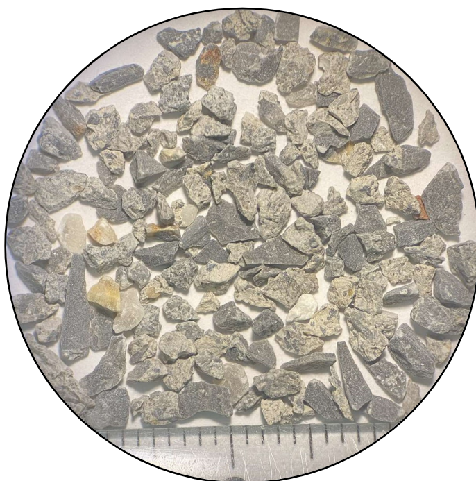
Εικόνα 3.28: Μικροφωτογραφία κόκκων από το κοκκομετρικό κλάσμα +1.00\text{mm} του δείγματος AN20.
