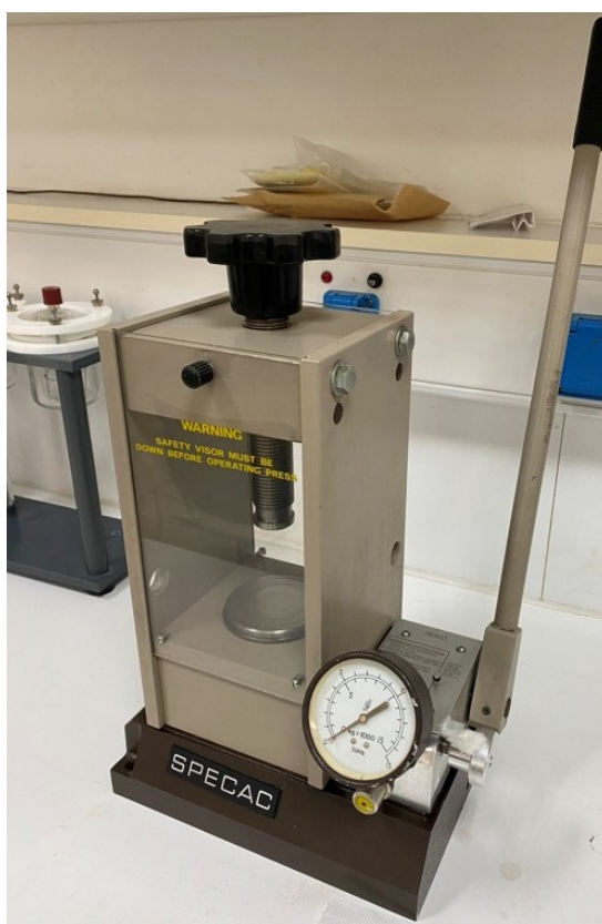
Εικόνα 3.12: Υδραυλική πρέσα Specac Press KBR25.011 για την παρασκευή των pellets για τη φασματοσκοπία FTIR.
