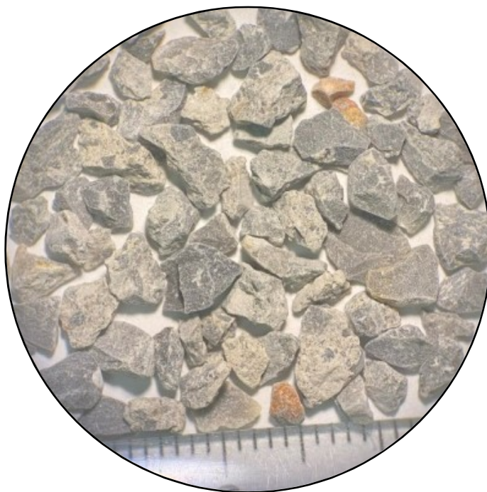
Εικόνα 3.21: Μικροφωτογραφία κόκκων από το κοκκομετρικό κλάσμα +2.00mm του δείγματος AN5.
