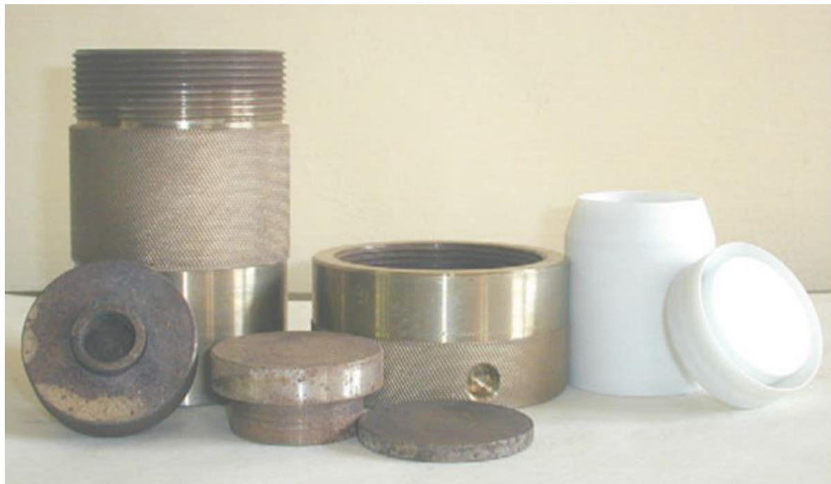
Εικόνα 9 Αυτόκλειστο δοχείο πίεσης και το δοχείο από Teflon για τις διαλυτοθερμικές- υδροθερμικές μεθόδους[14]
