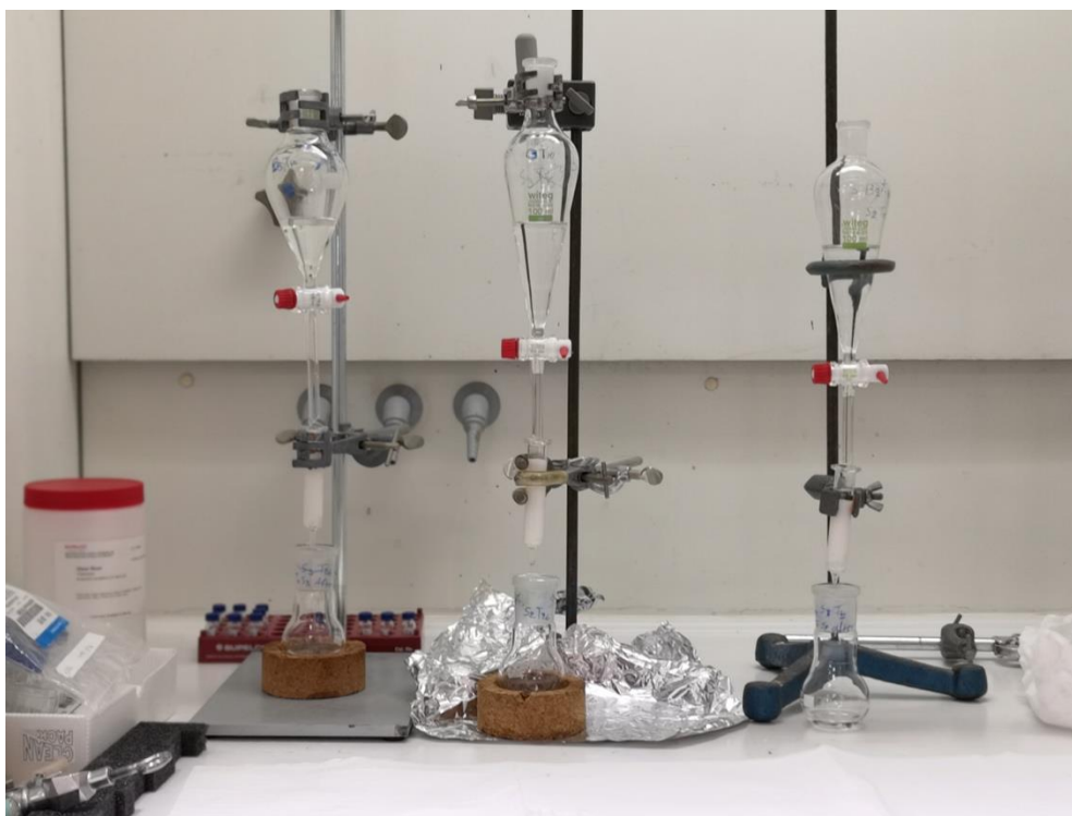
Εικόνα 3.7: Διάταξη εκχύλισης.
