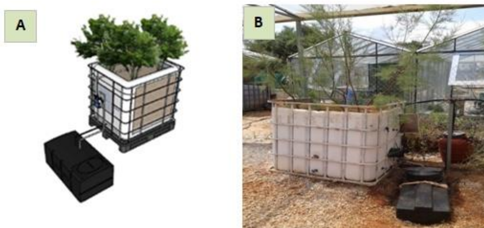
Εικόνα 11. (Α) Σχήμα και (Β) φωτογραφία της πιλοτικής μονάδας με τα φυτά T. parviflora .
