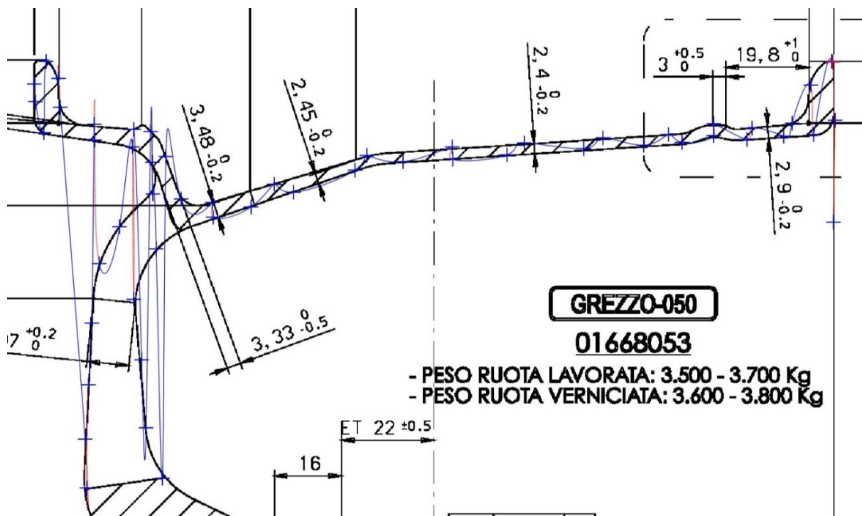
Εικόνα 2.5 Επιλογή σημείων προς ψηφιοποίηση, της πλάγιας όψης της ζάντας σε τομή, όπως παρουσιάζεται στην Εικόνα 2.2. Τα σημεία μαρκάρονται με σταυρούς σε μπλε απόχρωση.
