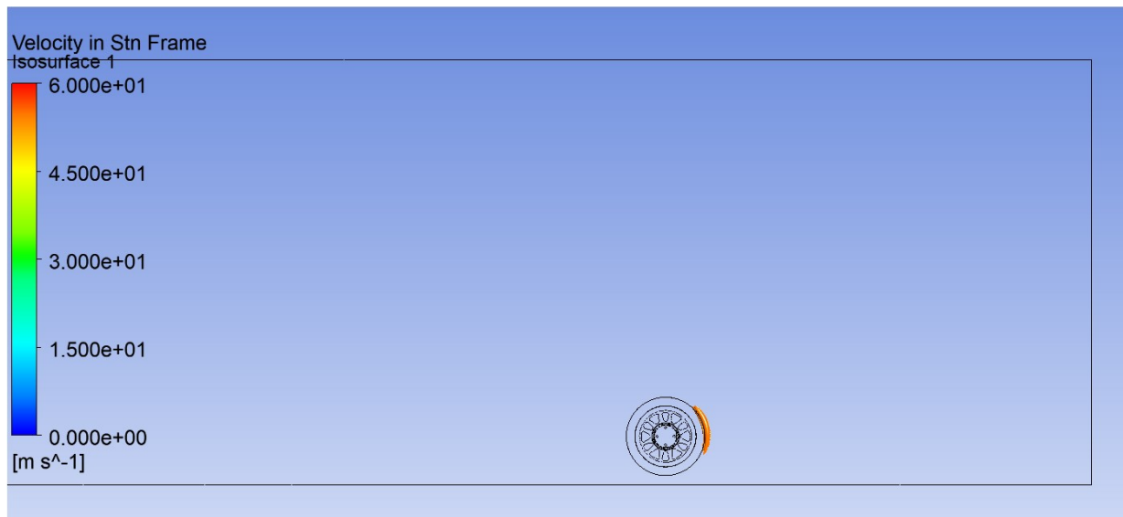
Εικόνα 3.54: Πλάγια χρωματική απεικόνιση της ταχύτητας της ροής του ρευστού (αέρας) ορισμένη στα 55 (m/s), γύρω από τον τροχό.
