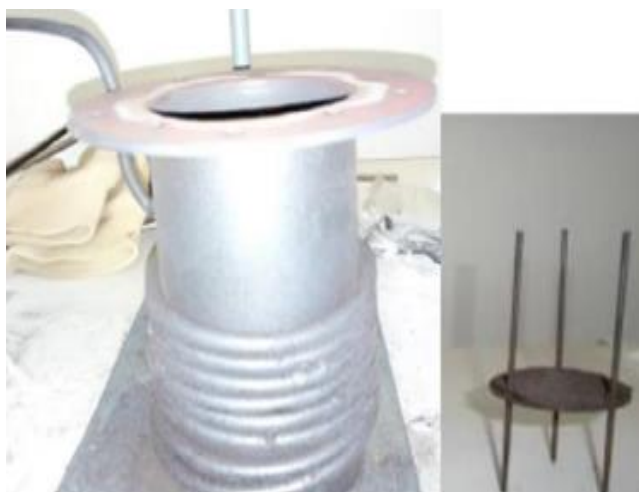
Εικόνα 3.6. Αντιδραστήρας από ανοξείδωτο χάλυβα και πυρίμαχη σίτα.
