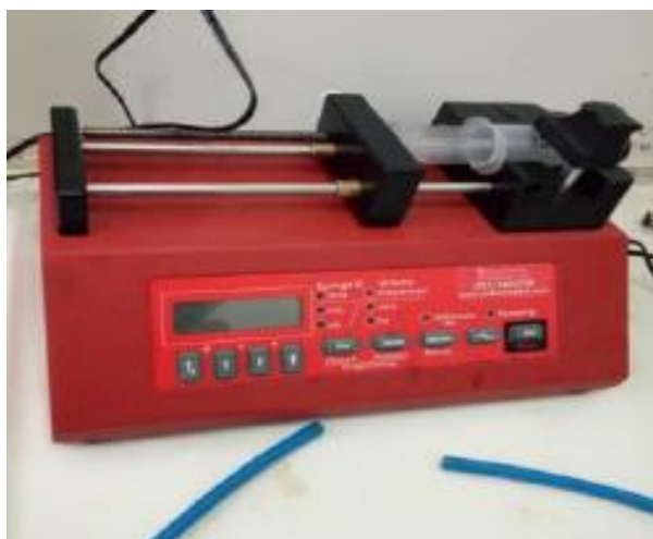
Εικόνα 3.7. Συσκευή παροχής ατμού με σωληνάκια σύνδεσης και σύριγγα με απιονισμένο νερό σε υγρή μορφή.
