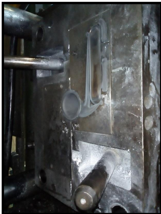
Εικόνα 118. Το σταθερό μέρος του καλουπιού τοποθετημένο στο σκελετό κατά τη χύτευση
