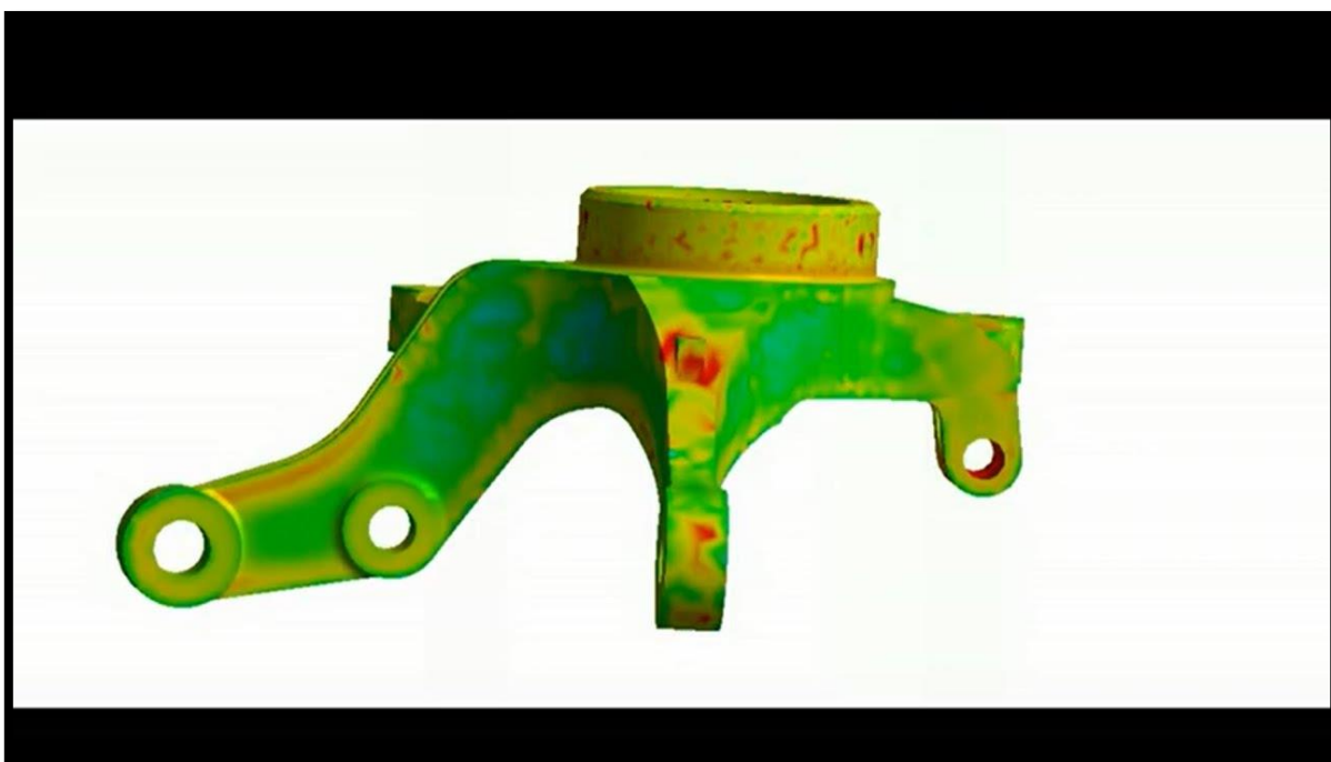
Εικόνα 24. Θερμική ανάλυση χυτού αντικειμένου μέσω του ANSYS CFD πηγή: Casting Component Thermal Analysis with Ansys CFD (youtube.com)
