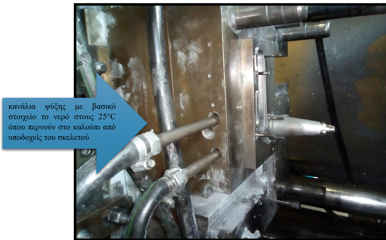
Εικόνα 26. Τοποθέτηση κώνου στο κινητό μέρος του καλουπιού χύτευσης
