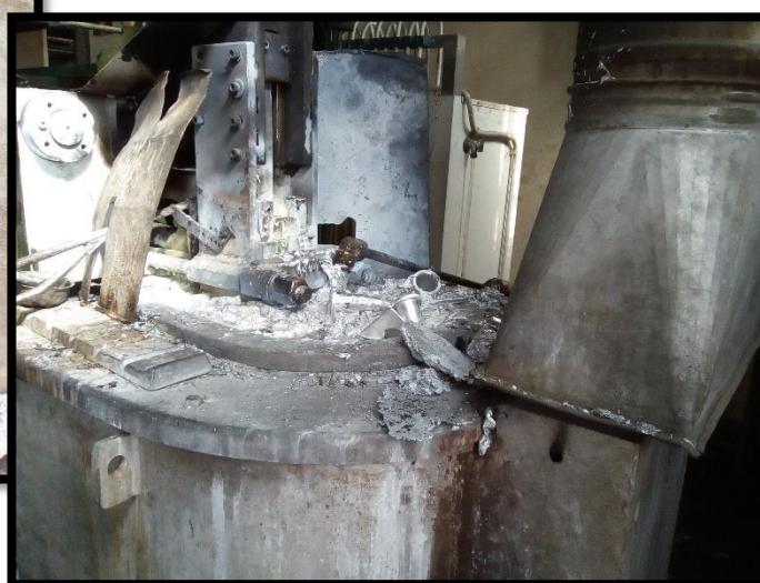
Εικόνες 18 & 19. Πίνακας ελέγχου θερμοκρασίας υγρού μετάλλου και φούρνος της χυτόπρεσσας 101A
