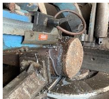
Σχήμα 4.2.2: Κοπή με πριόνι μετάλλου
