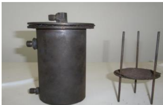
Εικόνα 3.6: Πυρολυτής Σταθερής Κλίνης
