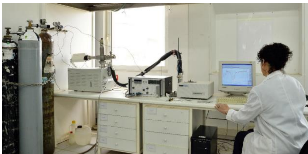
Εικόνα 3.8: Διάταξη Θερμοζυγού – Φασματογράφου TG-MS
