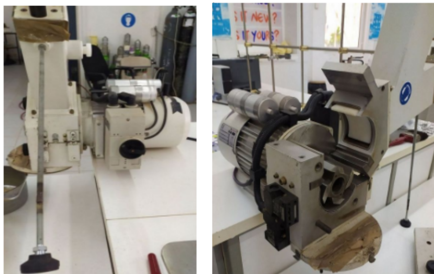
Εικόνα 3.2: Απεικόνιση μαχαιρόμυλου του εργαστηρίου Εξευγενισμού και Τεχνολογίας Στερεών Καυσίμων.
