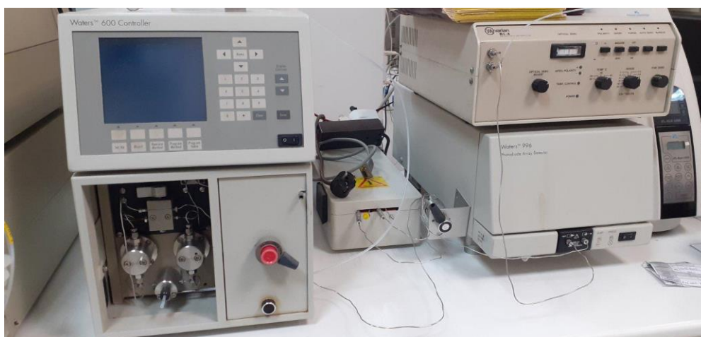
Εικόνα 12: Συσκευή υγρής χρωματογραφίας υψηλής πίεσης (High Pressure Liquid Chromatography-HPLC) του Εργαστηρίου Ανάλυσης Πυρήνων και Υπόγειων Ταμιευτήρων του Πολυτεχνείου Κρήτης
