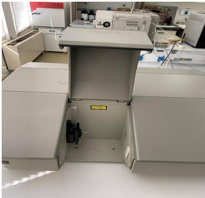
Εικόνα 10: Συσκευή υπέρυθρης φασματοσκοπίας μετασχηματισμού Fourier (FTIR) του Εργαστηρίου Ανάλυσης Πυρήνων και Υπόγειων Ταμιευτήρων του Πολυτεχνείου Κρήτης
