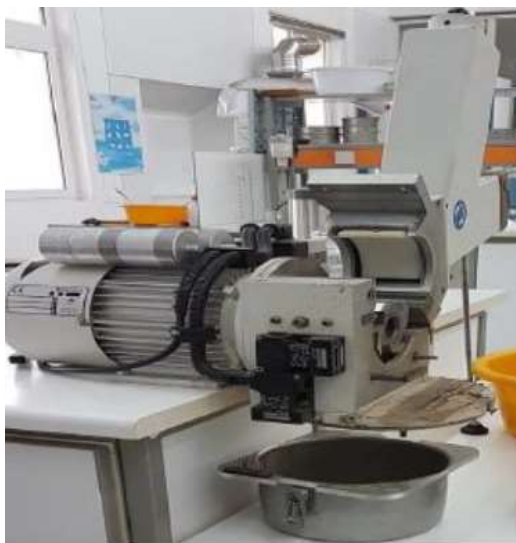
Σχήμα 3.1 Μαχαιρόμυλος τύπου Purverisette 15
