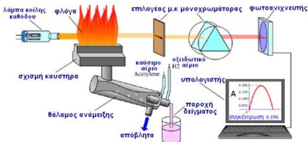
Εικόνα 4. 4Σχηματική παράσταση φλογοφασματοφωτόμετρου ατομικής απορρόφησης. (Σπανός, 2005)
