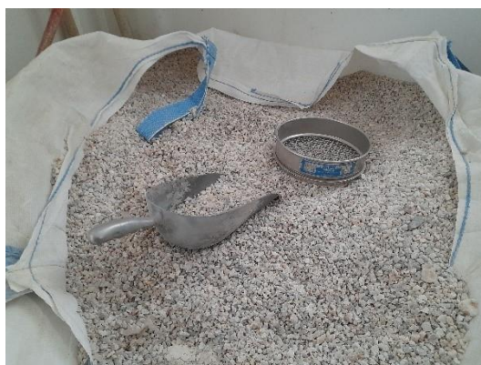
Φωτογραφία 7 | Χοντρόκοκκο αδρανές – γαρμπίλι. Χρησιμοποιήθηκε στις πρώτες δοκιμές και λόγω των προβλημάτων που δημιούργησε απορρίφθηκε η χρήση του.
