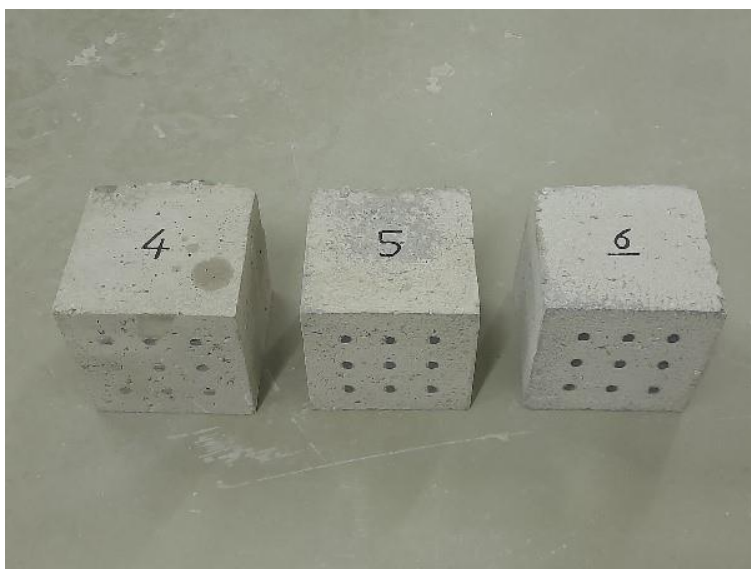
Φωτογραφία 17 | Τα τελικά δοκίμια αριθμούνται ώστε να είναι γνωστά τα χαρακτηριστικά τους.
