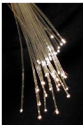
Εικόνα 9 | Το φως διαπερνά την οπτική ίνα και φτάνει στο άλλο της άκρο σχεδόν αναλλοίωτο.
