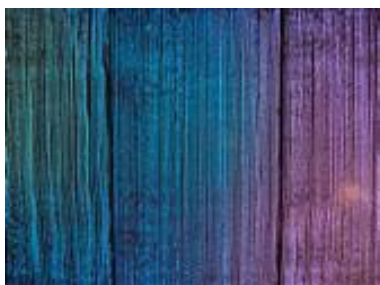
Εικόνα 19 | Πέρα από την ένταση του φωτός, οι οπτικές ίνες και άρα το διάφανο σκυρόδεμα μεταφέρουν και το χρώμα διευρύνοντας ακόμη περισσότερο το πεδίο εφαρμογής τους.
