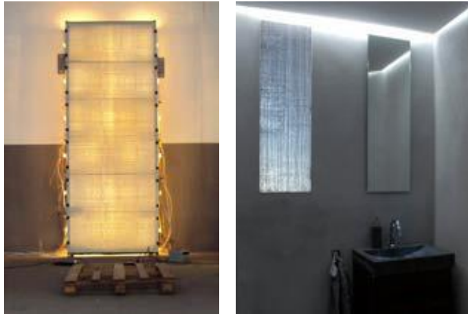
Εικόνες 28-29 | Αυτόφωτο στοιχείο. Το ένα άκρο της οπτικής ίνας βρίσκεται στην φωτεινή πηγή ενώ το άλλο μεταφέρει το φως στην εξωτερική επιφάνεια.
