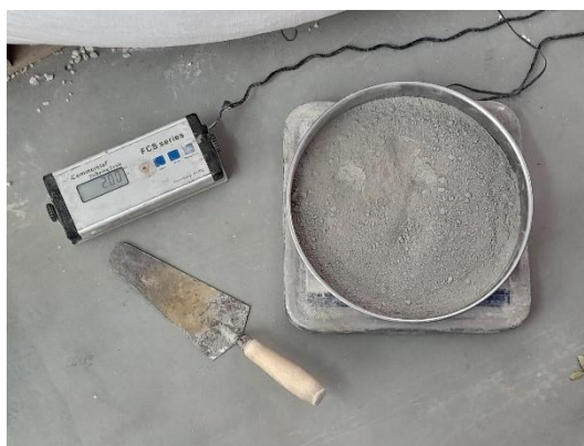
Φωτογραφία 14 | Διαδικασία ζύγισης των απαιτούμενων ποσοτήτων των υλικών
