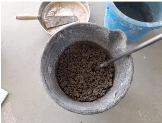
Φωτογραφία 18 | Το μείγμα της πρώτης δοκιμής ήταν ακατάλληλο λόγω της μεγάλης κοκκομετρίας των αδρανών που περιείχε.
