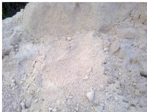
Εικόνα 13| Λεπτόκοκκο αδρανές, συνήθως κοσκινίζεται για να διαχωριστούν οι επιμέρους κοκκομετρίες.
