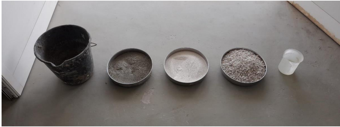
Φωτογραφία 4 | Τα υλικά που χρησιμοποιήθηκαν στις σκυροδετήσεις. Από αριστερά προς τα δεξιά: κουβάς ανάμιξης μείγματος, τσιμέντο, λεπτόκοκκο αδρανές, χοντρόκοκκο αδρανές και νερό.
