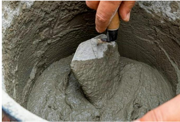
Εικόνα 12| Μείγμα τσιμεντοπολτού αποτελούμενο από νερό και τσιμέντο στην κατάλληλη κάθε φορά αναλογία.
