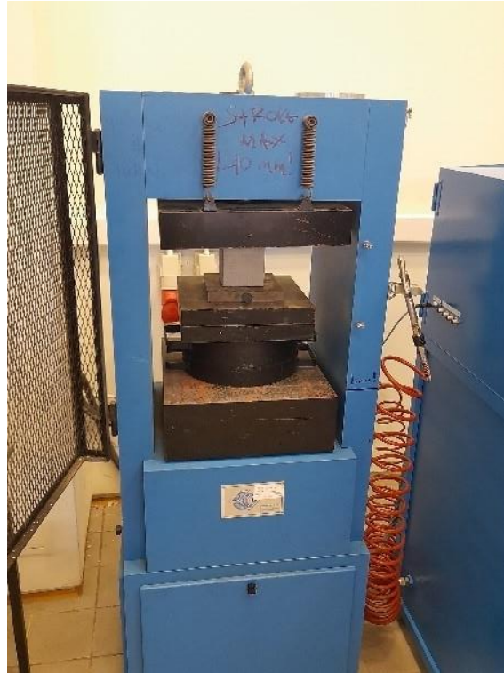
Φωτογραφία 33 | Πρέσα η οποία μετρά την θλιπτική αντοχή κάθε δοκιμίου, στο εργαστήριο του Πολυτεχνείου.
