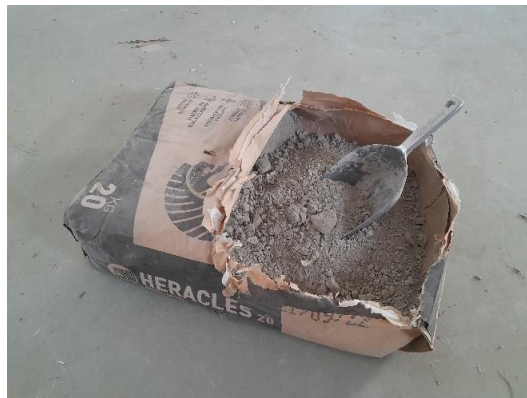
Φωτογραφία 5 | Σακί με τσιμέντο. Αφού ζυγιζόταν η επιθυμητή ποσότητα αναμειγνύονταν με νερό δημιουργώντας τον τσιμεντοπολτό (συνδετική ουσία του σκυροδέματος)
