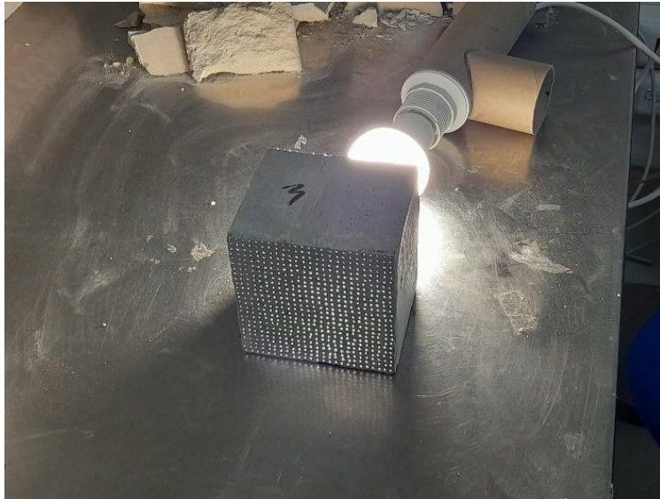
Φωτογραφία 30 | Το φως περνά μέσα από το δοκίμιο διάφανου σκυροδέματος.
