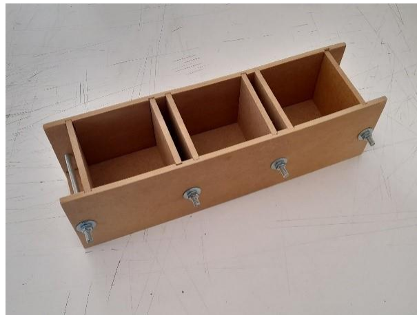
Φωτογραφία 25 | Νέο καλούπι αποτελούμενο από 3 μήτρες, για ταυτόχρονη σκυροδέτηση από το ίδιο μείγμα.
