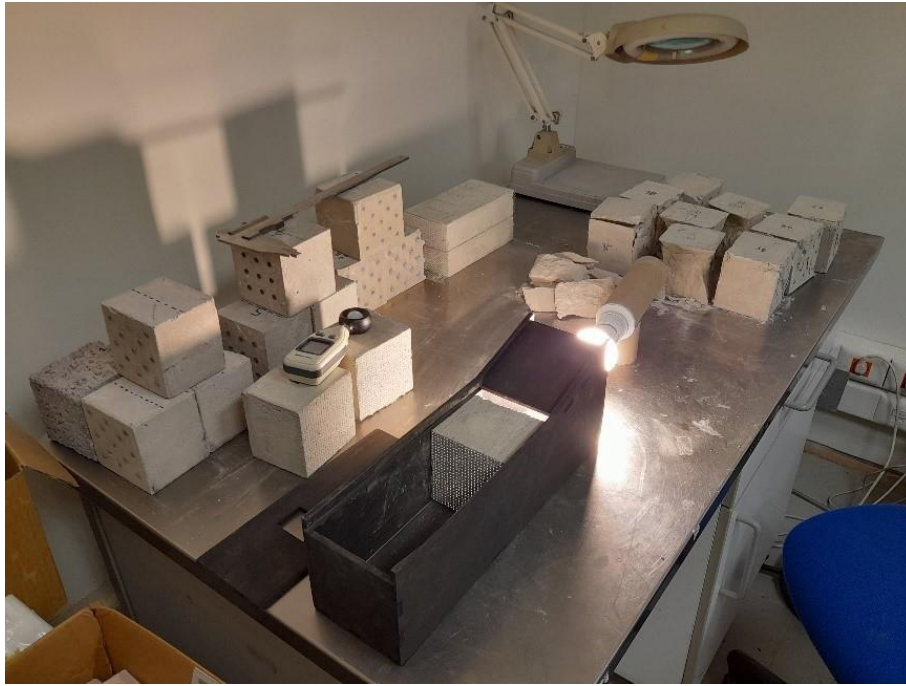
Φωτογραφία 31 | Η διάταξη μέτρησης της φωτοδιαπερατότητας
