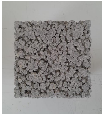
Φωτογραφία 19 | Φωτογραφίες του δοκιμίου της πρώτης σύστασης. Η εικόνα απέχει πολύ από το αναμενόμενο.
