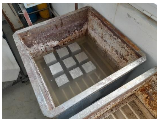
Φωτογραφία 16 | Δεξαμενή στην οποία τα δοκίμια παρέμεναν για 28 μέρες μετά το ξεκαλούπωμα.
