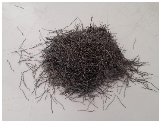
Φωτογραφία 11 | Το μεταλλικό fiber το οποίο χρησιμοποιήθηκε.
