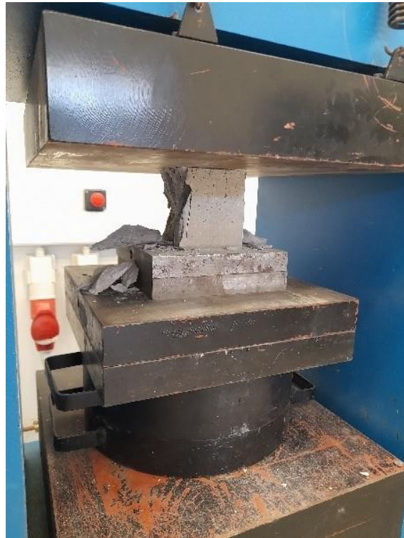
Φωτογραφία 29 | Δοκίμιο αμέσως μετά την μέτρηση της θλιπτικής του αντοχής. Το δοκίμιο καταστρεφόταν κατά την διαδικασία της μέτρησης.
