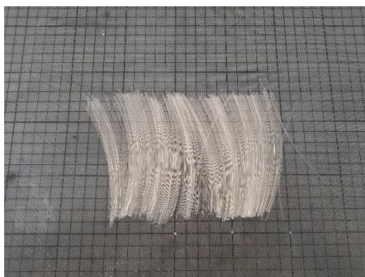
Φωτογραφία 9 | Οπτικές ίνες. Σε κάθε δοκίμιο τοποθετούνταν 625 κομμάτια.
