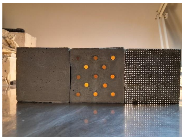
Φωτογραφία 36 | Οι τρεις διαφορετικές κατηγορίες φωτοδιαπερατότητας που μετρήθηκαν. Συμβατικό σκυρόδεμα / Διάφανο σκυρόδεμα με ράβδους σιλικόνης (με την χρήση μεταλλικού fiber και χωρίς) / Διάφανο σκυρόδεμα με οπτικές ίνες.
