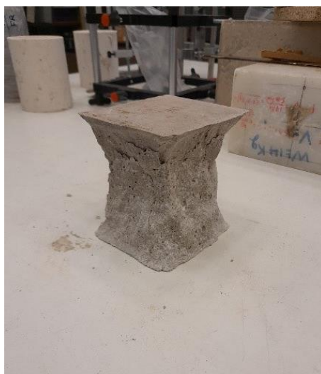
Φωτογραφία 38 | Δοκίμιο συμβατικού σκυροδέματος μετά την μέτρηση του ορίου θραύσης του.
