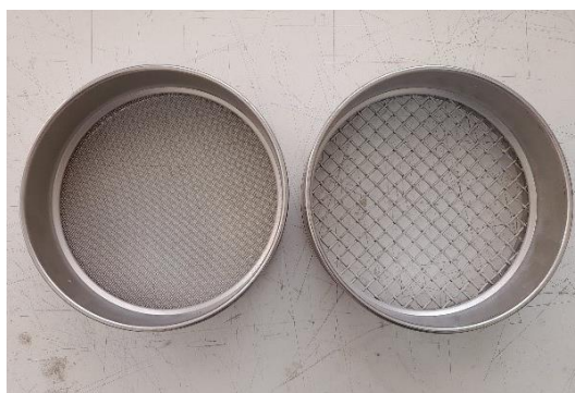
Φωτογραφία 6 | Τα κόσκινα που χρησιμοποιήθηκαν. Αριστερά το κόσκινο Νο5 της σειράς με μάτι 1,18mm και δεξιά το κόσκινο Νο8 της σειράς με μάτι 9,5mm.
