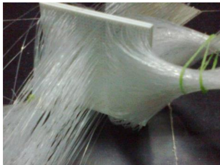
Εικόνα 37 | Λόγω της μικρής διατομής και του πλήθους των οπτικών ινών που απαιτούνται για την κατασκευή διάφανου σκυροδέματος, η διαδικασία καθίσταται ιδιαίτερα απαιτητική.
