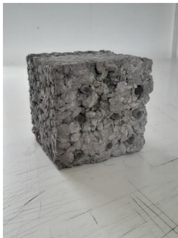
Φωτογραφία 19 | Φωτογραφίες του δοκιμίου της πρώτης σύστασης. Η εικόνα απέχει πολύ από το αναμενόμενο.
