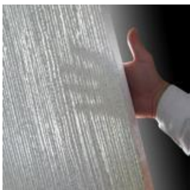
Εικόνα 18 | Επιφάνεια διάφανου σκυροδέματος. Διακρίνονται οι γραμμές τοποθέτησης των ινών.
