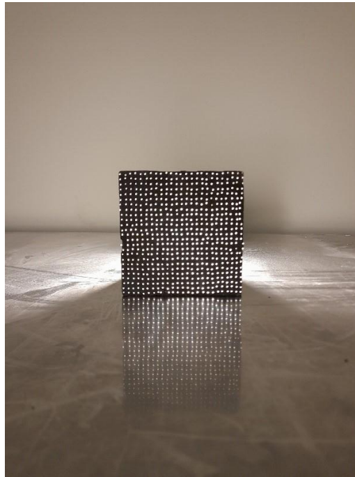
Φωτογραφία 35 | Δοκίμιο διάφανου σκυροδέματος κατασκευασμένο από οπτική ίνα.
