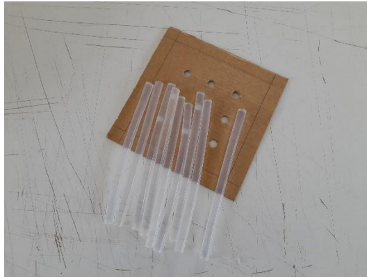
Φωτογραφία 10 | Οι αρχικές ράβδοι σιλικόνης που χρησιμοποιήθηκαν στο στάδιο ανεύρεσης κατάλληλης σύστασης υλικών.
