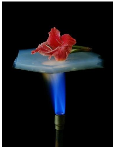
Εικόνα 2 | Αεροπήκτωμα (aerogel), έξυπνο υλικό με μικρή θερμική αγωγιμότητα.
