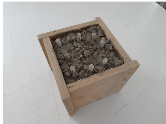
Φωτογραφία 18 | Το μείγμα της πρώτης δοκιμής ήταν ακατάλληλο λόγω της μεγάλης κοκκομετρίας των αδρανών που περιείχε.
