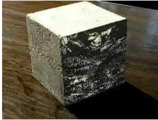
Εικόνα 17 | Δοκίμιο διάφανου σκυροδέματος με οπτική ίνα πολύ μικρής διατομής. Λόγω της μικροσκοπικής κλίμακας η τοποθέτηση των ινών σε οργανική μορφή κρίνεται η καταλληλότερη.
