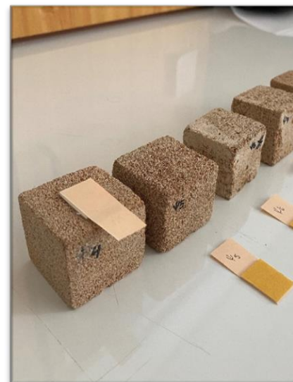
Εικ.69: Εφαρμογή κολλητικής ταινίας πάνω στην επιφάνεια του λίθου Πηγή: Προσωπικό αρχείο.
