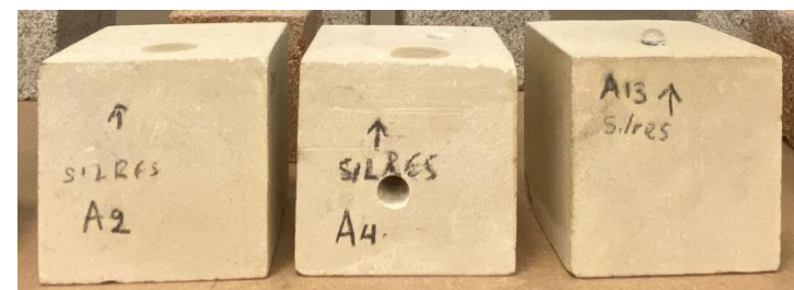
Εικ:86: Δοκίμιο A2,A4 μηδενική γωνία επαφής,δοκίμιο A13 γωνία επαφής > 90^\circ
