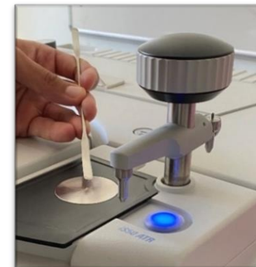
Εικ.83: Τοποθέτηση υλικού στο IS50 ATR. Πηγή: Προσωπικό αρχείο.
