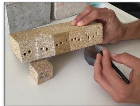
Εικ.80: Φθείρουμε την επιφάνεια ώστε να συγκεντρώσουμε την απαραίτητη ποσότητα στερεού δείγματος.
