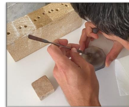
Εικ.81: Συγκέντρωση στερεού δείγματος από την εξεταζόμενη επιφάνεια.
