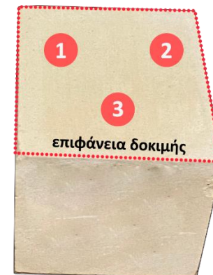
Εικ.65: Τα τρία διαφορετικά σημεία δοκιμής πάνω στην επιφάνεια treated.
