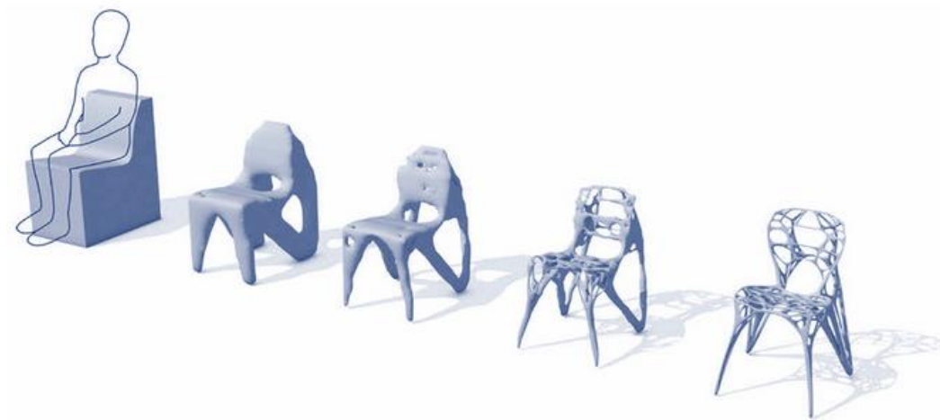
Εικόνα 1. Τοπολογική βελτιστοποίηση καθίσματος. Πηγή: Generico: A case study on performance-based design [2].
