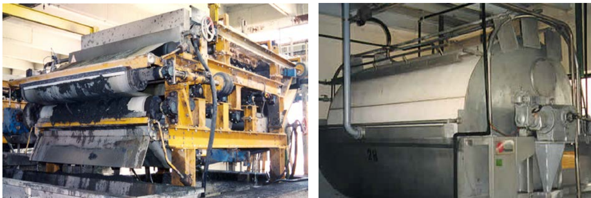
Εικόνα 2.2 Αφυδάτωση ιλύος με φυγοκέντριση (πάνω αριστερά), με κλίνες ξήρανσης (πάνω δεξιά), με ταινιοφιλτρόπρεσσα (κάτω αριστερά), με ηθμό κενού (κάτω δεξιά) (Γκίκας, 2020).
