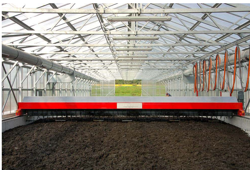
Εικόνα 2.7 Κλειστή εγκατάσταση (τύπου θερμοκηπίου) ηλιακής ξήρανσης ιλύος με μηχανική ανάδευση. (ENOX Sp. z o.o., 2023).
