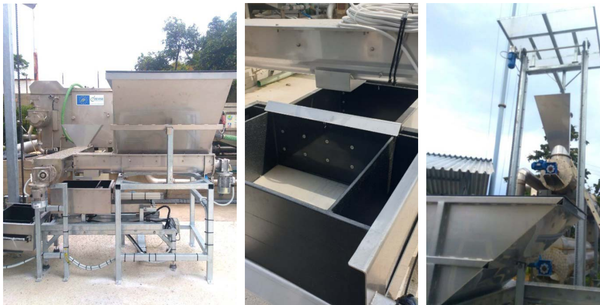
Εικόνα 5.7 Φωτογραφίες του συνδυαστικού συστήματος τροφοδοσίας του ξηραντηρίου (χοάνες και μεταφορικοί κοχλίες για τα μικροκοσκινισμένα βιοστερεά και την ξηραμένη δευτεροβάθμια ιλύ, ζυγιστικό/δοσομετρικό δοχείο και αναβατήριο).
