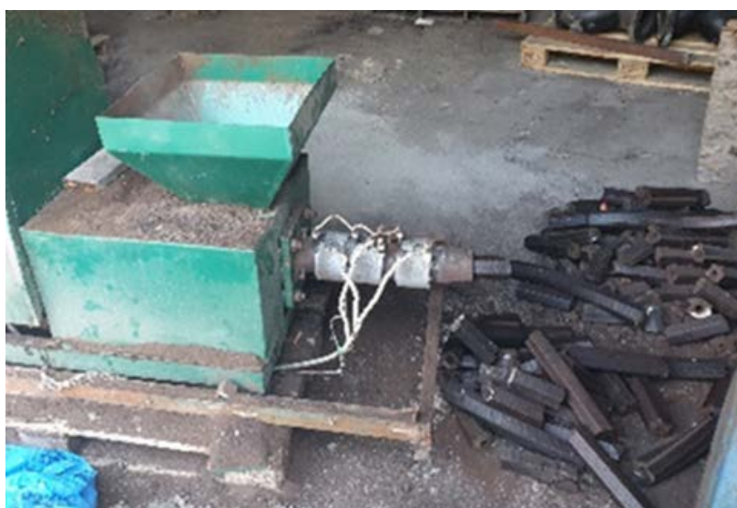
Εικόνα 7.1 Μικροκοσκινισμένα βιοστερεά σχηματισμένα σε συμπαγείς και σταθεροποιημένες μπρικέτες.
