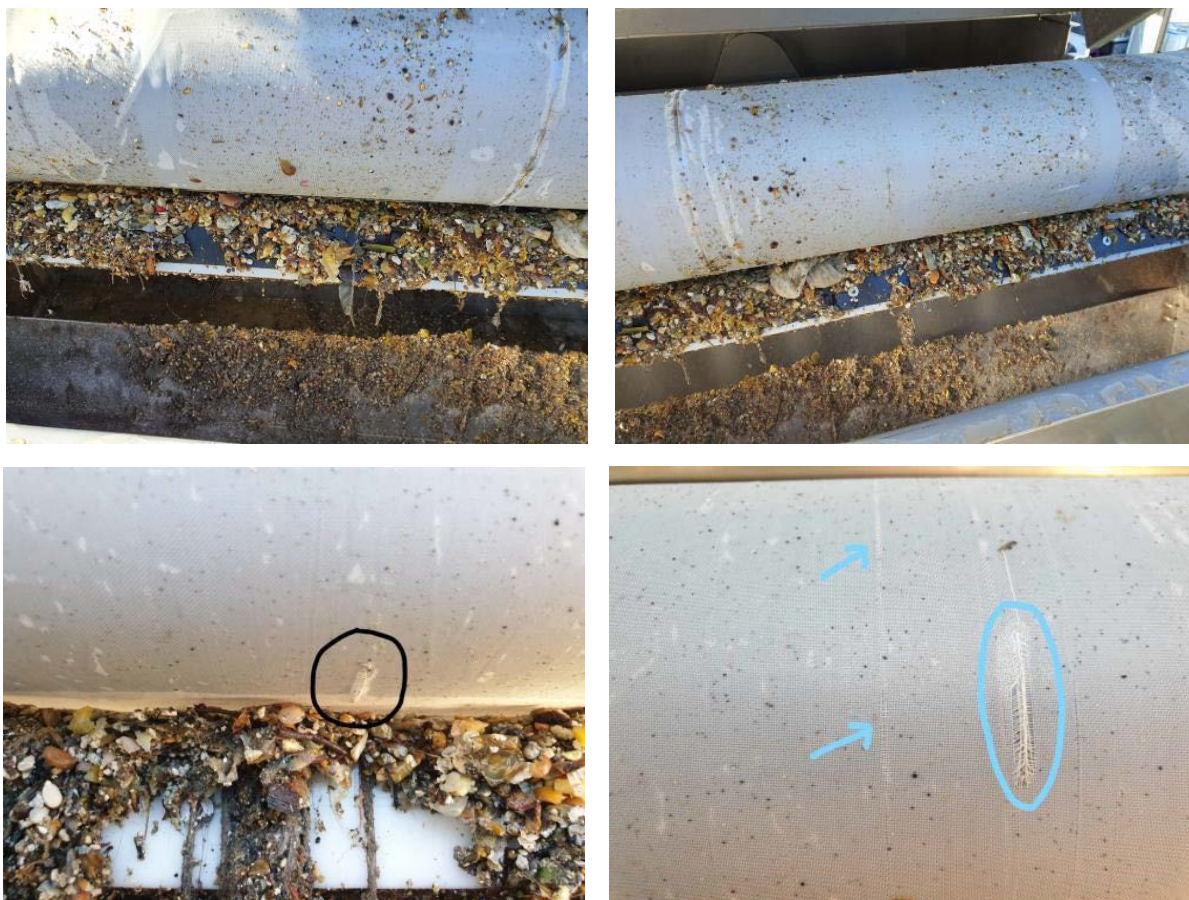
Εικόνα 10.4 Φωτογραφίες του φίλτρου του μικροκόσκινου που έχει σκιστεί λόγω των χαλικιών που υπήρχαν στο εισερχόμενο απόβλητο.
