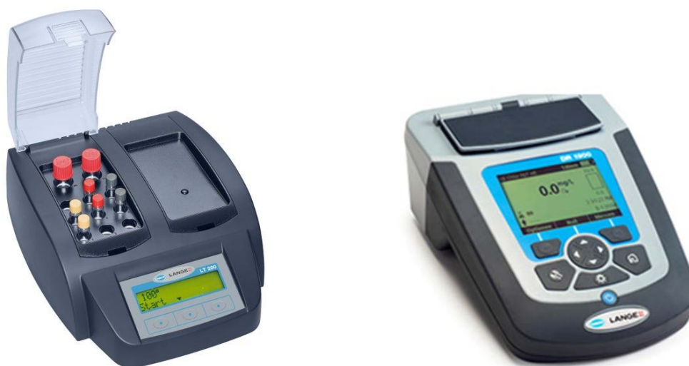
Εικόνα 6.6 Θερμοαντιδραστήρας Hach LT 200 (αριστερά) και φωτόμετρο Hach DR 1900 (δεξιά).
