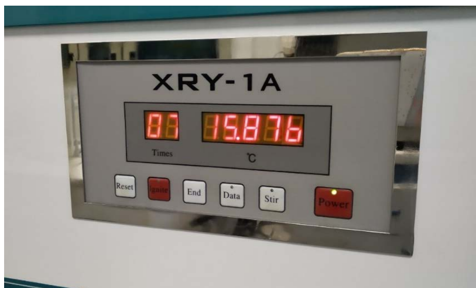
Εικόνα 6.13 Ηλεκτρονικός πίνακας μετρήσεων, όπου φαίνονται ο αύξων αριθμός μετρήσεων και οι τιμές της θερμοκρασίας. Στο κάτω μέρος του πίνακα φαίνονται τα κουμπιά Reset, Ignite, End, Data, Stir, Power.
