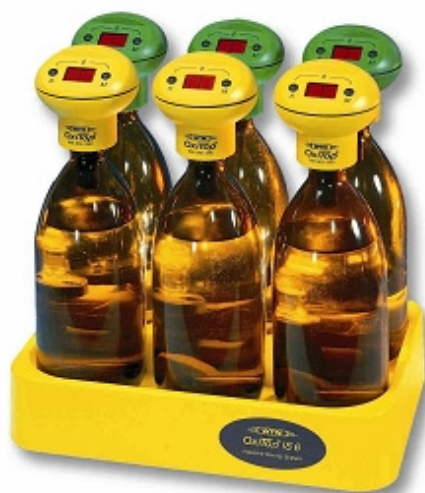
Εικόνα 6.4 Μπουκάλια δειγματοληψίας BOD με συσκευές μέτρησης WTW OxiTop και μαγνητική βάση ανάδευσης WTW IS6 Stirrer (αριστερά) και ψυχόμενος επωαστικός κλίβανος Pol-Eko ST2 (δεξιά).
