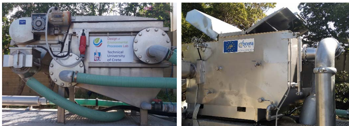
Εικόνα 5.4 Φωτογραφίες πειραματικού (αριστερά) και πιλοτικού (δεξιά) μικροκόσκινου, που χρησιμοποιήθηκαν στο έργο LIFE B2E4sustainable-WWTP.
