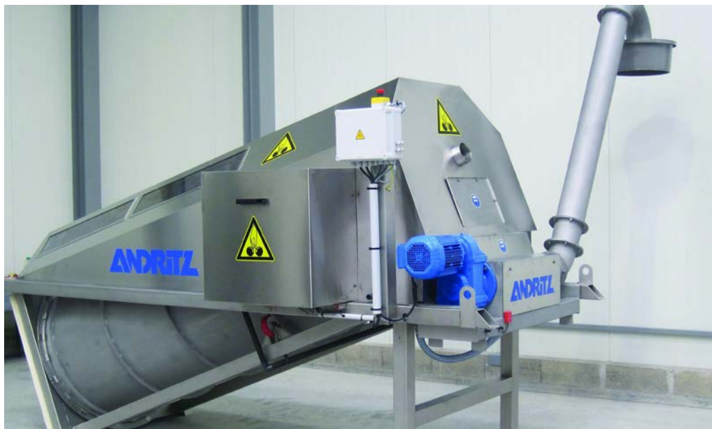
Εικόνα 7.2 Το λεπτοκόσκινο «AQUADRUM - AD-1000-1-B» της εταιρίας ANDRITZ S.A.S που είναι εγκατεστημένο στην ΕΕΛ Ηρακλείου.
