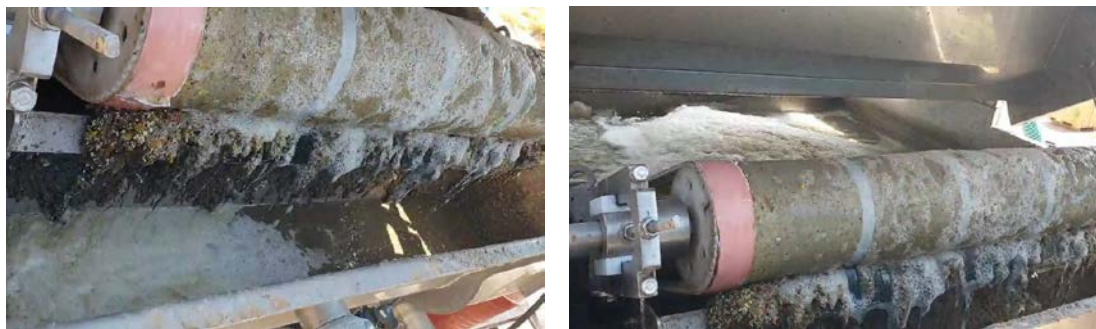
Εικόνα 10.5 Έντονη δημιουργία αφρού στο απόβλητο κατά τις δοκιμές κροκίδωσης του πιλοτικού μικροκόσκινου.
