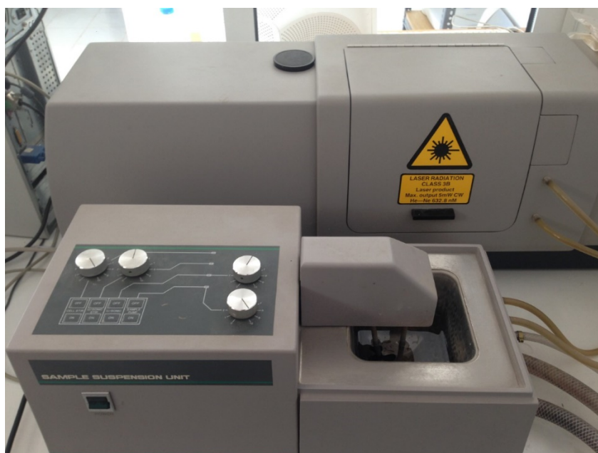
Εικόνα 6.7 Αναλυτής μεγέθους σωματιδίων Malvern Mastersizer S, με σκέδαση ακτινών λέιζερ.
