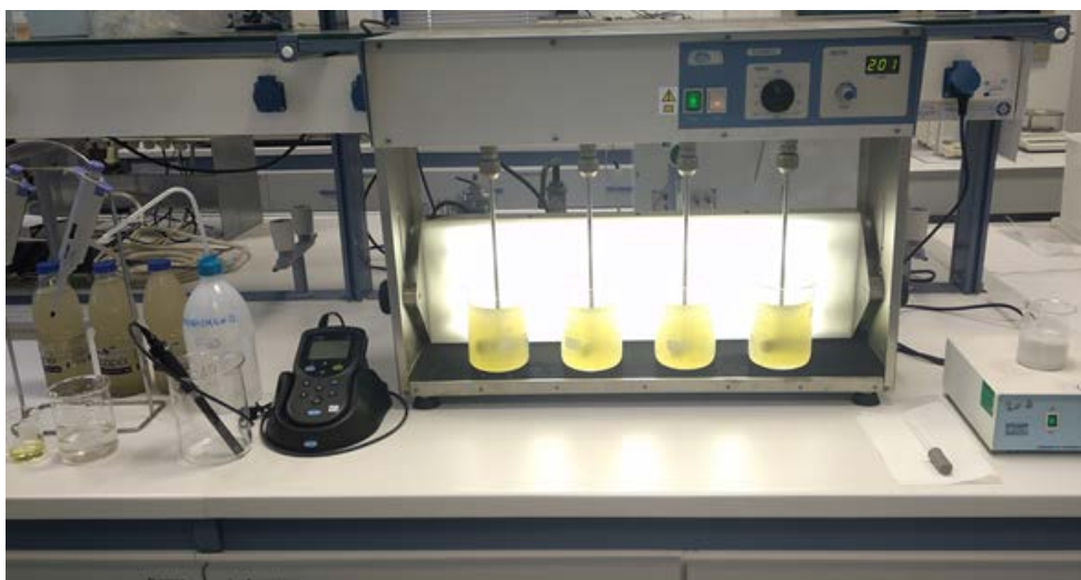
Εικόνα 10.2 Πειραματική διάταξη για δοκιμές κροκίδωσης στο εργαστήριο.
