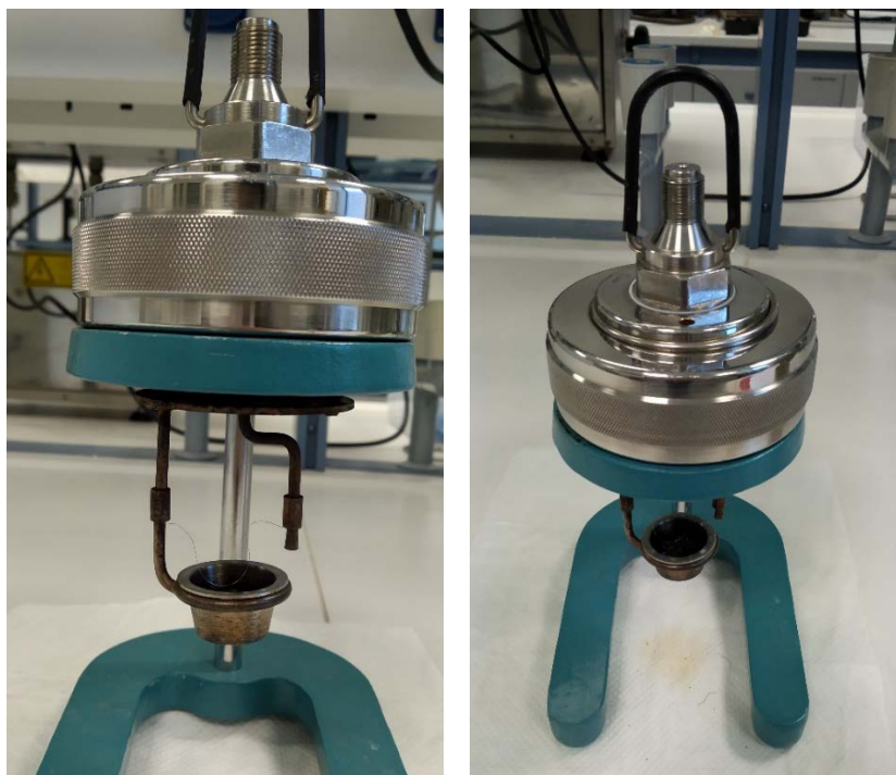
Εικόνα 6.10 Κεφαλή βόμβας οξυγόνου με δείγμα και σύρμα ανάφλεξης.
