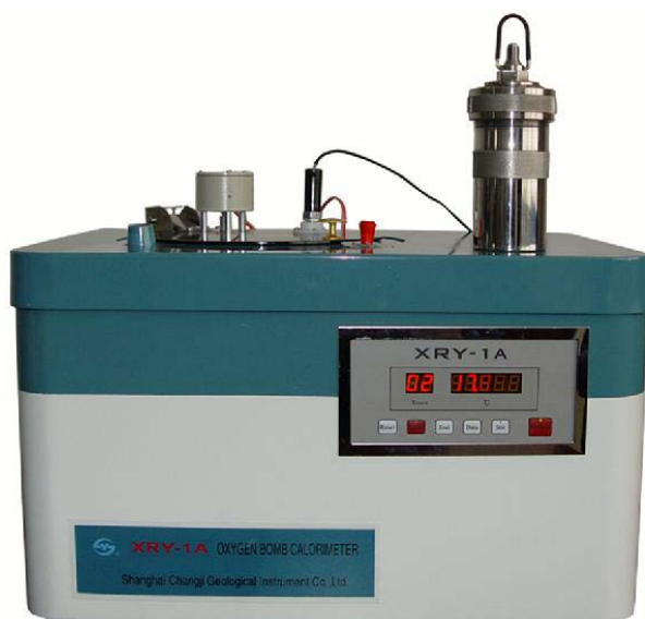
Εικόνα 6.9 Το θερμιδόμετρο XRY-1A Oxygen Bomb Calorimeter που χρησιμοποιήθηκε για τον προσδιορισμό της θερμογόνου δύναμης.
