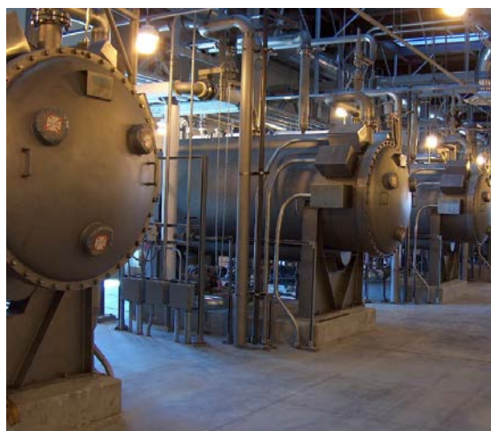
Εικόνα 1.9 Βιομηχανική συσκευή παραγωγής O_3 (αριστερά) και αντιδραστήρας UV ανοικτού αγωγού (δεξιά) (Ξεκουκουλωτάκης, 2023).
