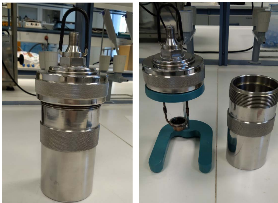
Εικόνα 6.11 Βόμβα οξυγόνου κυλινδρικού σχήματος εντός της οποίας βρίσκονται το δείγμα, το σύρμα, καθώς και το απαραίτητο νερό και οξυγόνο.
