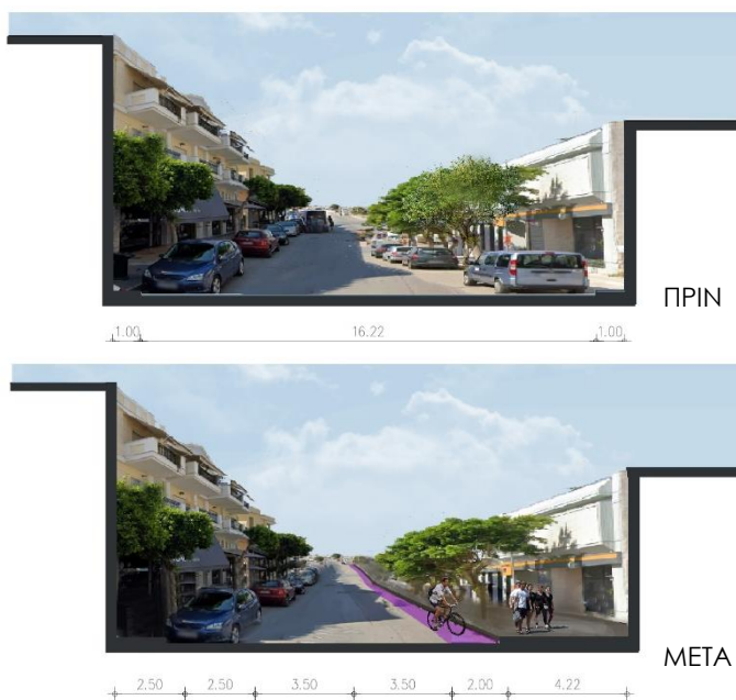
Εικόνα 4.13: Ενδεικτική τομή σε σημείο του κύριου οδικού άξονα
