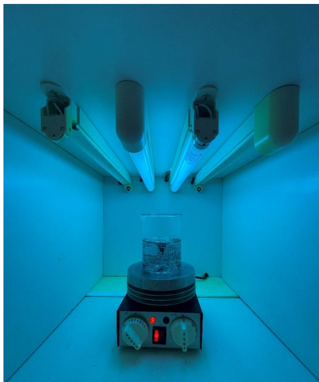
Εικόνα 14: Διεξαγωγή πειράματος με δύο UVA λαμπτήρες να βρίσκονται σε λειτουργία
