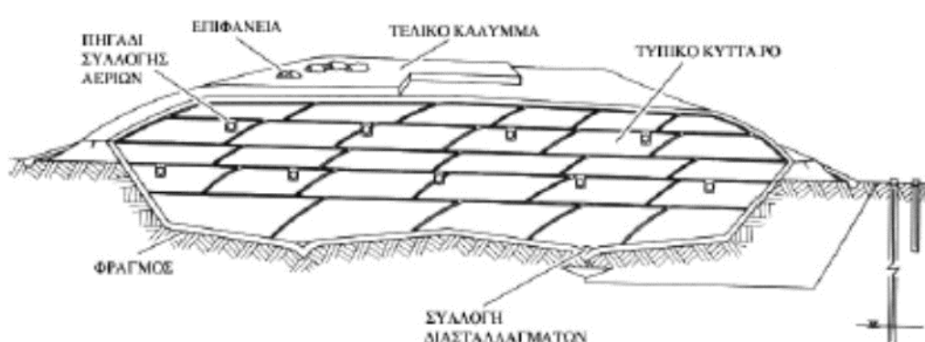
Εικόνα 4 : Δομή και χαρακτηριστικά ενός ΧΥΤΑ (Tchobanoglous, 1993)
