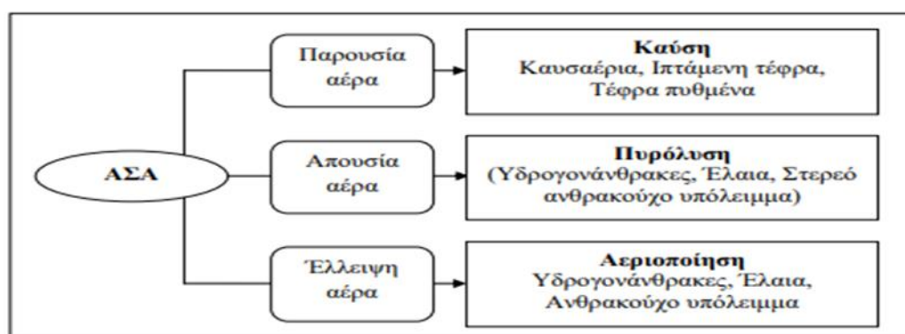
Εικόνα 2 : Σχηματική απεικόνιση θερμικής επεξεργασίας ΑΣΑ(Στούπας Χ., 2020).
