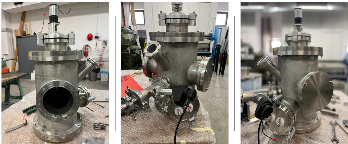
Εικόνα 40: Δοκιμή του θαλάμου για την ασφαλή λειτουργία και την βέλτιστη αποδοτικότητα του.
