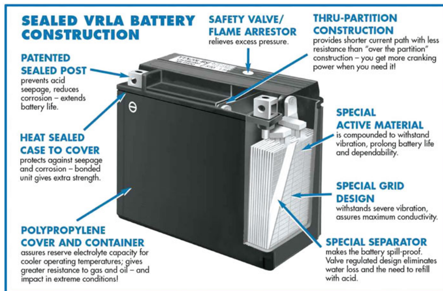
Εικόνα 2.3: Σχηματική διάταξη μπαταρίας μόλυβδου-οξέος ( https://technolysis-hts.gr/βαση-γνωσεων/μπαταρίες-μολύβδου-οξέως-κλειστού-τύ/ )
