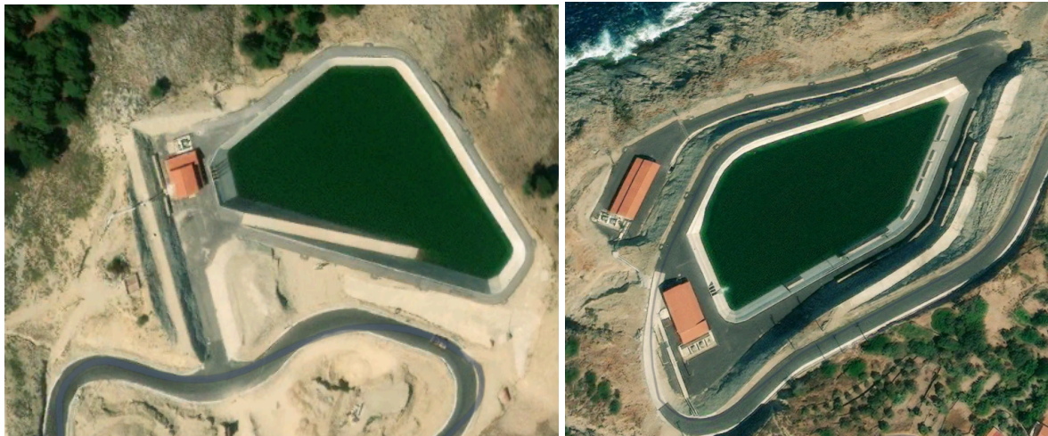
Εικόνα 3.3: Ο άνω και κάτω ταμιευτήρας του υδροηλεκτρικού συστήματος αποθήκευσης «Ναέρας» στην Ικαρία, (ΔΕΗ Ανανεώσεις, 2019)
