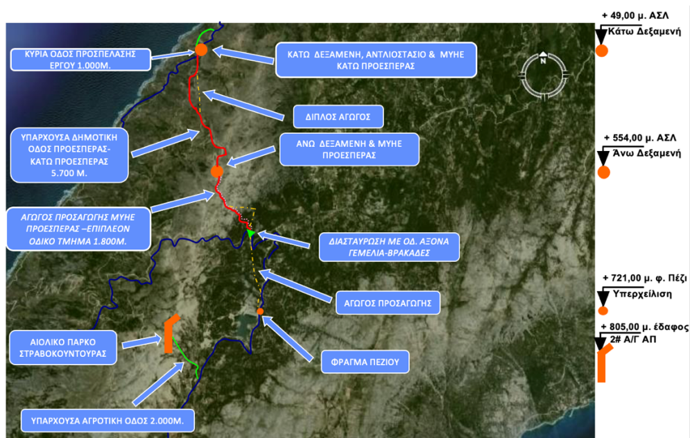
Εικόνα 3.4: Διάταξη του υδροηλεκτρικού συστήματος αποθήκευσης «Ναέρας» στην Ικαρία, (ΔΕΗ Ανανεώσεις, 2019)
