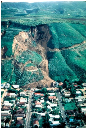
Εικόνα 2.1 Κατολίσθηση και ροή εδαφικής μάζας το 1995 στην Νότια Καλιφόρνια (USGS, 2004).
