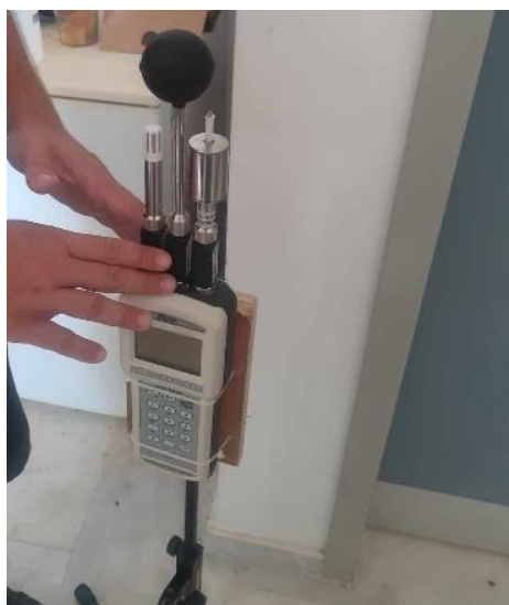
Εικόνα 26. Φωτογραφίες της διάταξης του φορητού τριποδικού μετεωρολογικού σταθμού από το εργαστήριο
