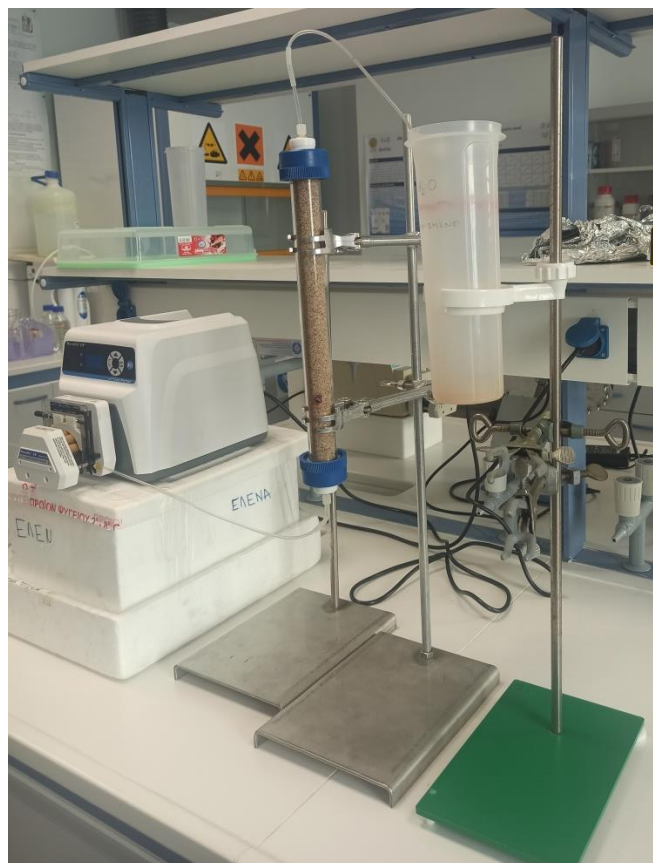
Εικόνα 6.2 : Πειραματική Διάταξη Κορεσμού της Στήλης
