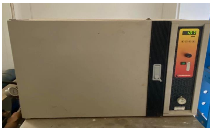
Εικόνα 27: Εργαστηριακός φούρνος ξήρανσης.
