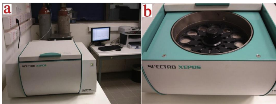
Εικόνα 18: α. Φασματοσκόπιο ακτίνων X φθορισμού τύπου SPECTRO – XEPO της AMETEK και β. αυτόματος δειγματολήπτης 12 θέσεων (Πηγή: Kallithrakas-Kontos et al., 2020).
