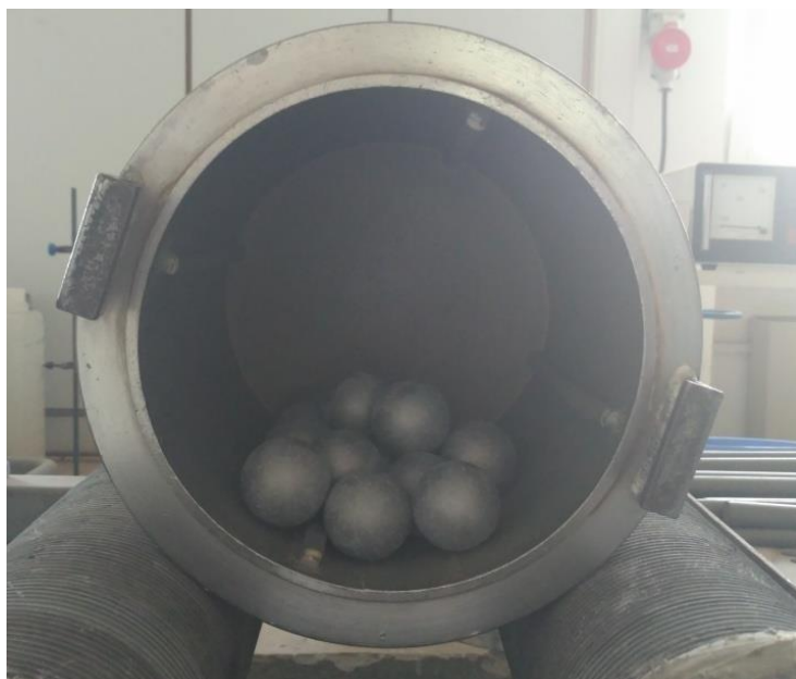
Εικόνα 23: Εργαστηριακός σφαιρόμυλος τύπου Sepor (Batch ball mill).
