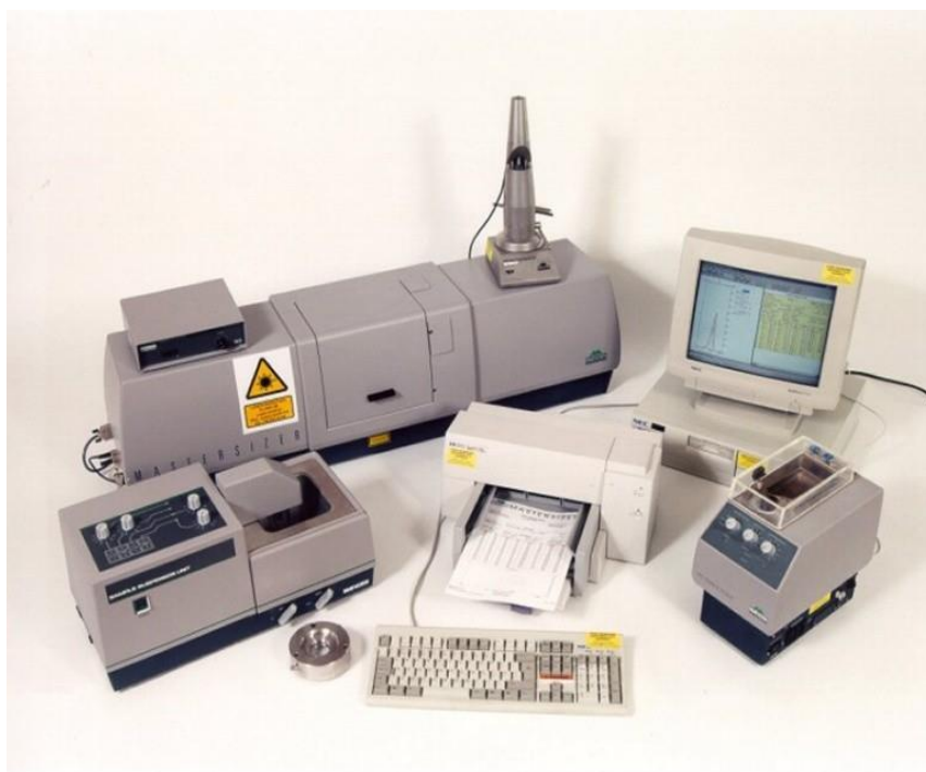
Εικόνα 24: Κοκκομετρικός αναλυτής Mastersizer S της Malvern (Πηγή: Πετράκης, 2004).
