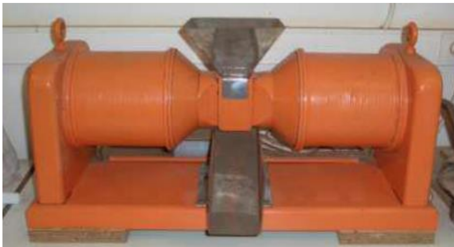
Εικόνα 25: Εργαστηριακός υγρός μαγνητικός διαχωριστής υψηλής κλίσης πεδίου.
