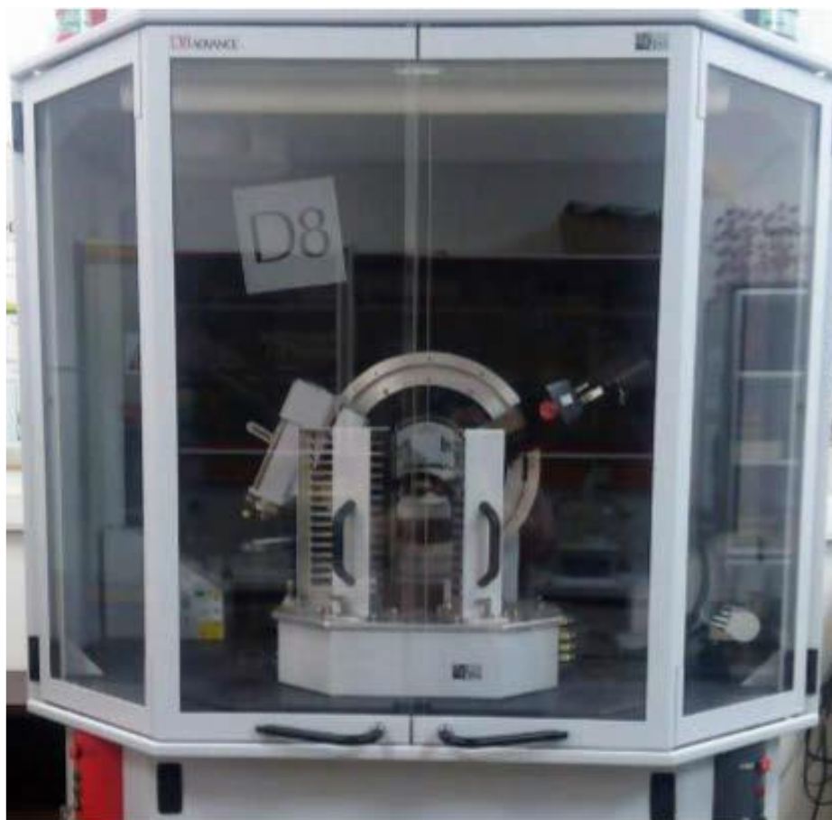
Εικόνα 17: Περιθλασίμετρο ακτίνων X τύπου D8 – Advance.
