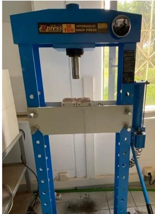
Εικόνα 28: Υδραυλική πρέσα συμπίεσης.
