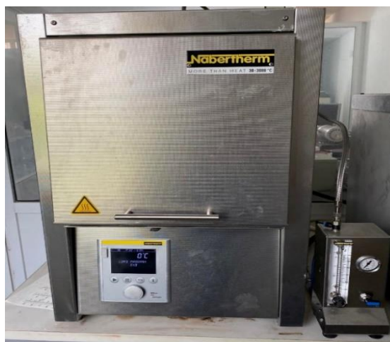
Εικόνα 26: Κλίβανος υψηλών θερμοκρασιών LHT 08/18 της Nabertherm.
