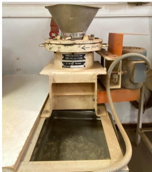
Εικόνα 22: Εργαστηριακός κωνικός σπαστήρας.
