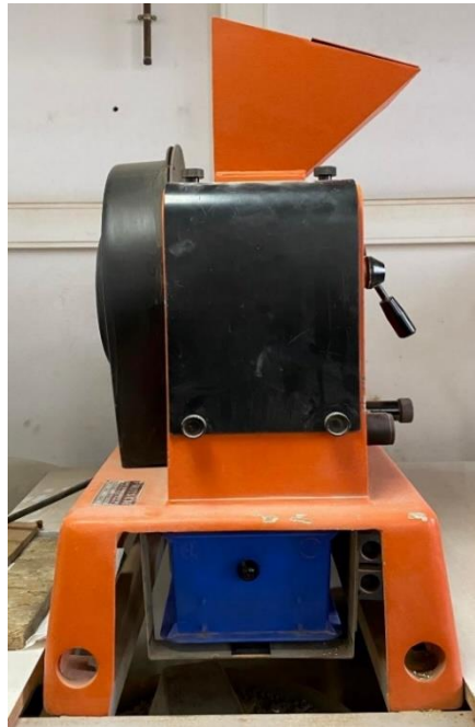
Εικόνα 21: Σιαγονωτός σπαστήρας FRITSCH pulverisette 1.
