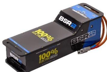
Εικόνα 7.14: μπαταρία για απλό ηλεκτρικό kart ενηλίκων ισχύος 15 kW
