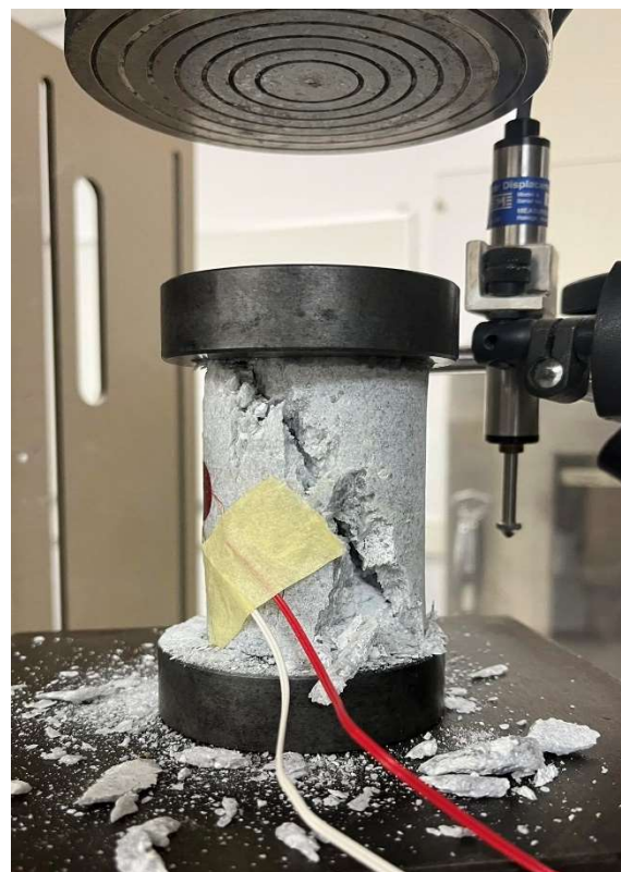
Σχήμα 4.7: Βασική ρωγμή δοκιμίου 2
