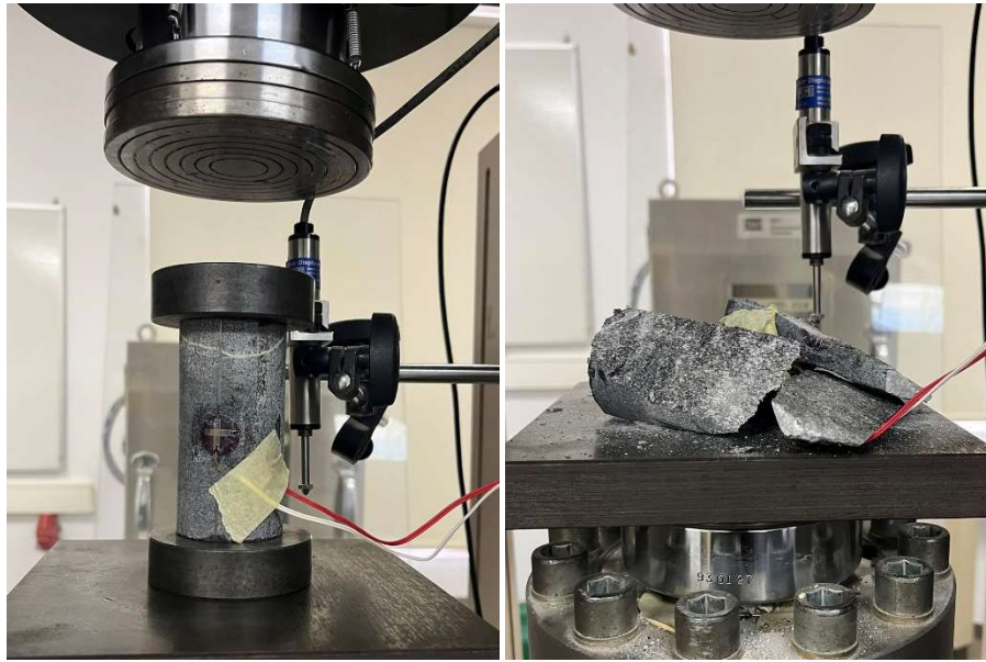
Σχήμα Α.1: Δοκίμιο Νο1 πριν και μετά την εφαρμογή μονοαξονικής θλίψης
