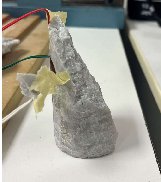
Σχήμα 4.15: Βασική ρωγμή δοκιμίου 17
