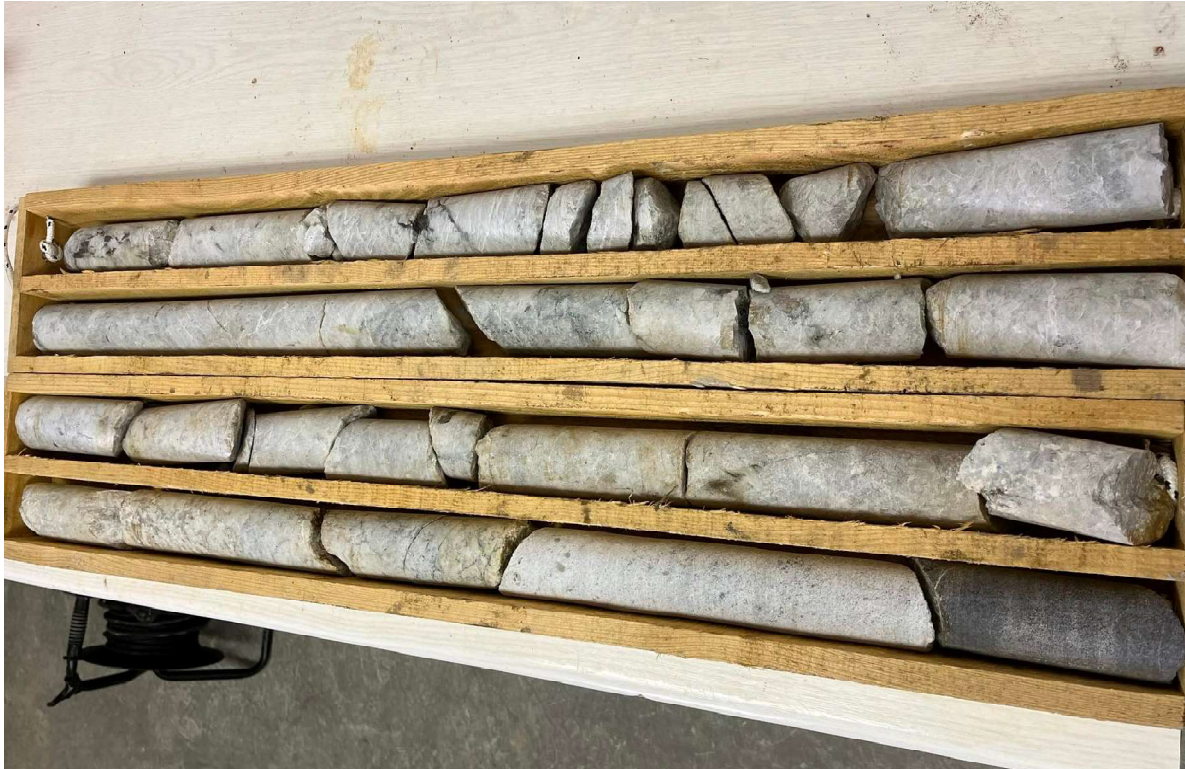
Σχήμα 2.2: Δειγματοληψία πετρώματος με τη μορφή γεωτρητικού συνεχομένου πυρήνα.
