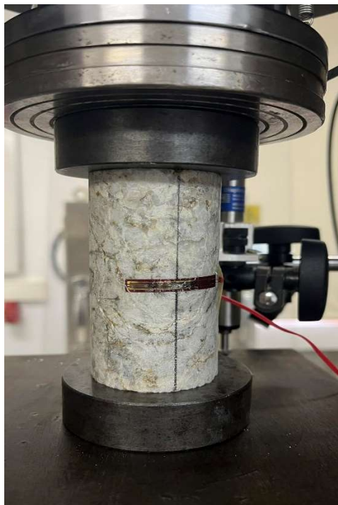
Σχήμα 4.8: Δοκίμιο 5 με οριζόντιο μηκυνσιόμετρο
