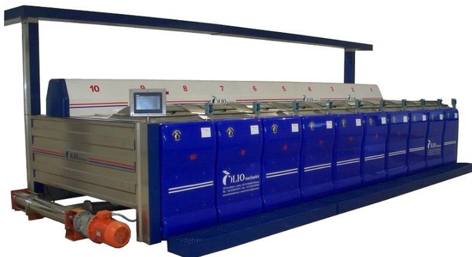
Σχήμα 4.6 Συγκρότημα από Μαλακτήρες
