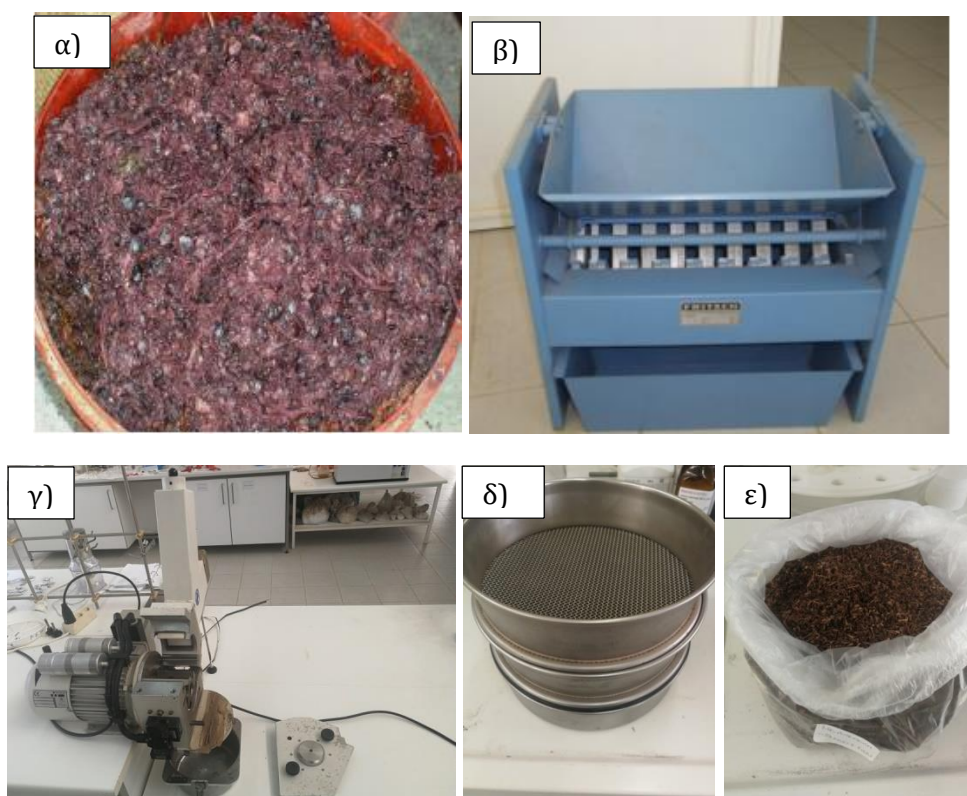
Εικόνα 3.1: α) Αρχικό δείγμα, β) Διαχωριστής Jones, γ) Μαχαιρόμυλος Pulverisette 15, δ) Κόσκινο -1 mm, ε) Τελικό δείγμα
