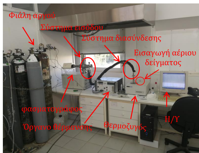
Εικόνα 3.8: Διάταξη θερμοζυγού (TG) – φασματογράφου μάζας (MS)
